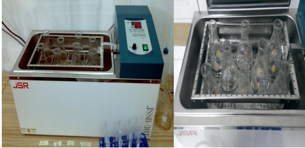
Şekil 2.8. Çalkalamalı su banyosu ve Yıkanma düzeneği
