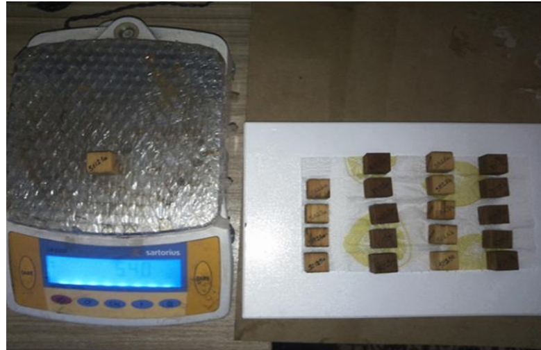
Şekil 2.10. Ağırlık ölçümlerinin hassas terazi ile yapılması
