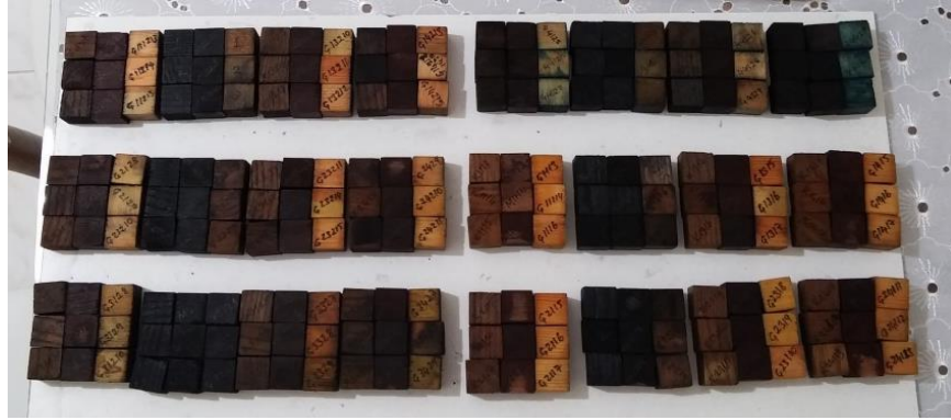
Şekil 2.7. Boyar çözelti uygulanmış deney örnekleri
