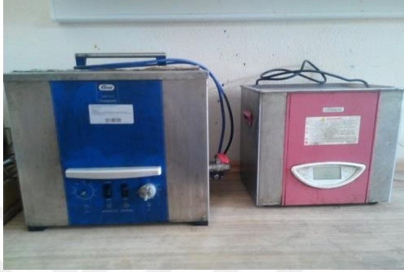
Şekil 2.6. Sıcaklık ve zaman ayarlı ekstraksiyon kazanı
