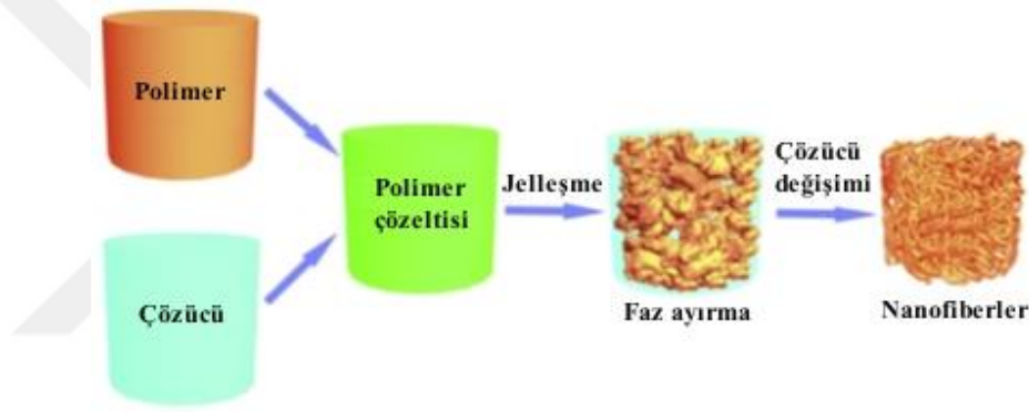
Şekil 1.3. Faz ayırma yönteminin şematik gösterimi
