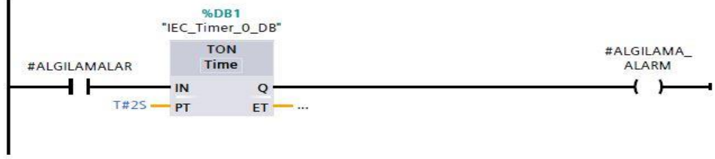
Şekil 3. 30. Yangın Algılama Alarm Çalışması
