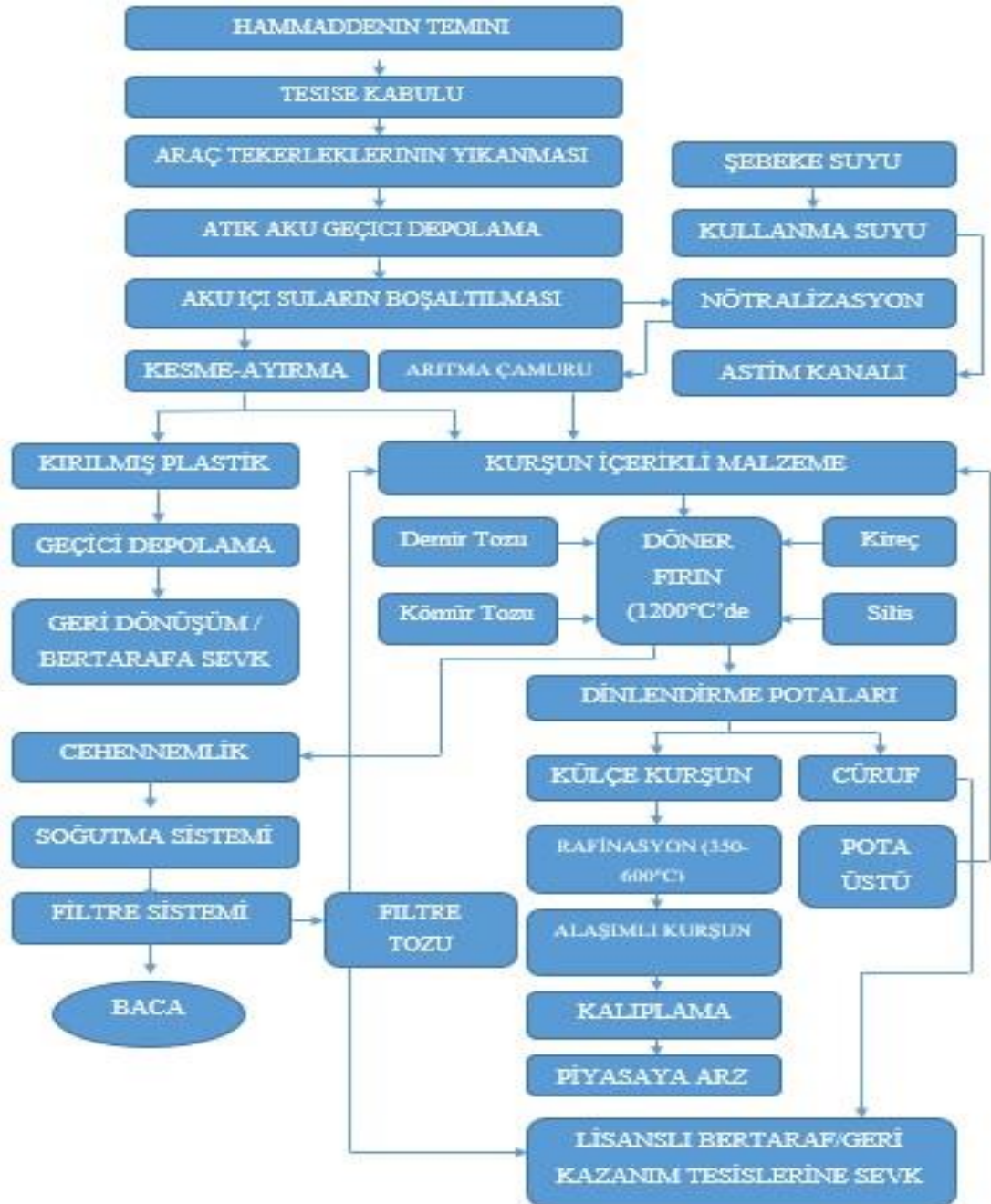
Çizelge 3.6. Akü Üretim ve Geri Kazanım Ünitesi İş Akım Şeması
