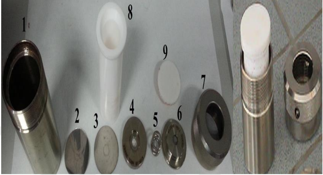
Şekil 2. 7 Sindirme reaktörü ve parçaları. (1) reaktörün dış kabı, (2) korozyon diski, (3) patlama diski, (4) düşük basınç plakası, (5) basınç plakalarını dengeleyici yay, (6) yüksek basınç plakası, (7) reaktörün dış kapağı, (8) teflon kap ve (9) teflon kapak
