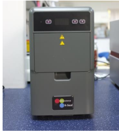
Şekil 3.6. KASP deneylerinde plate üzerini kapatmak için kullanılan K-seal cihazı
