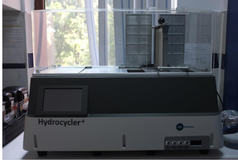
Şekil 3.7. KASP deneylerinde kullanılan su banyosu temelli PZR’da kullanılan Hydrocycler cihazı
