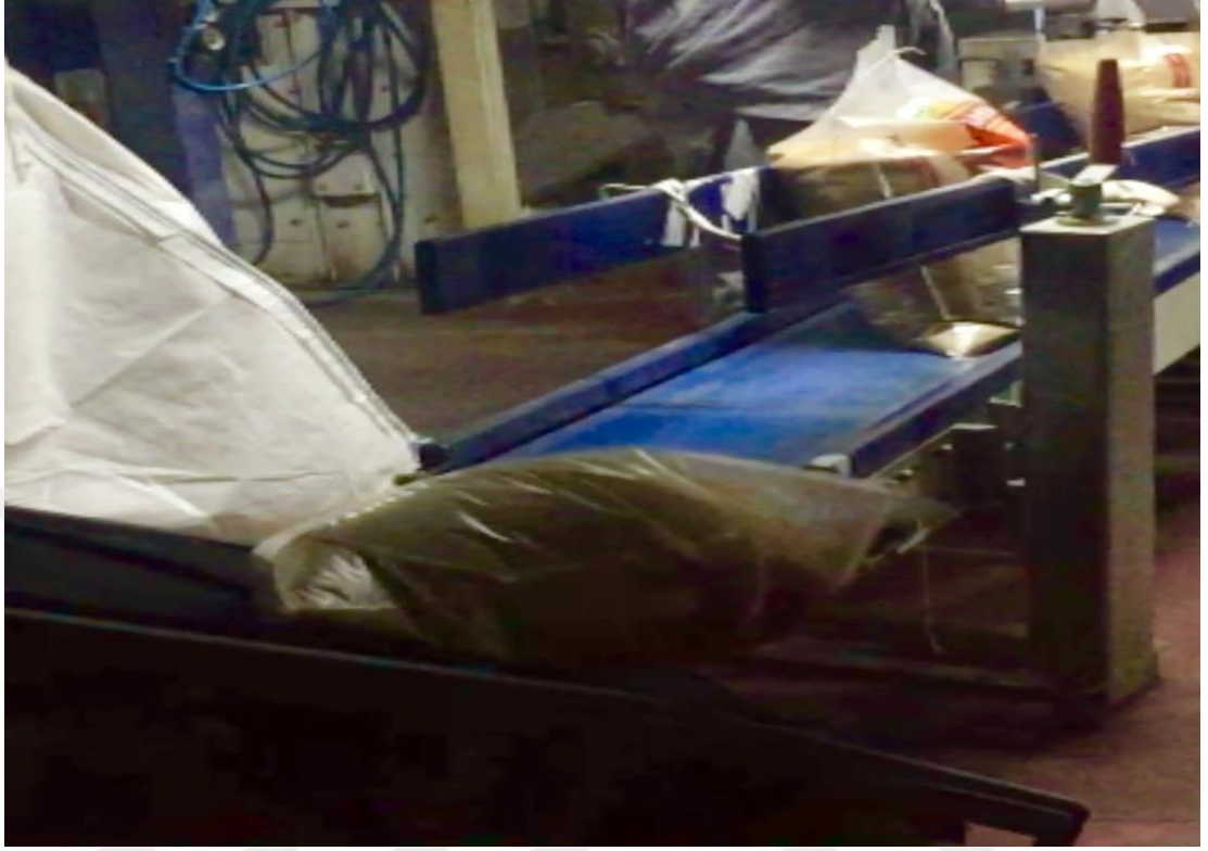
Görsel 4. 7: Çuvalın devrilip II numaralı konveyöre düşmesi
