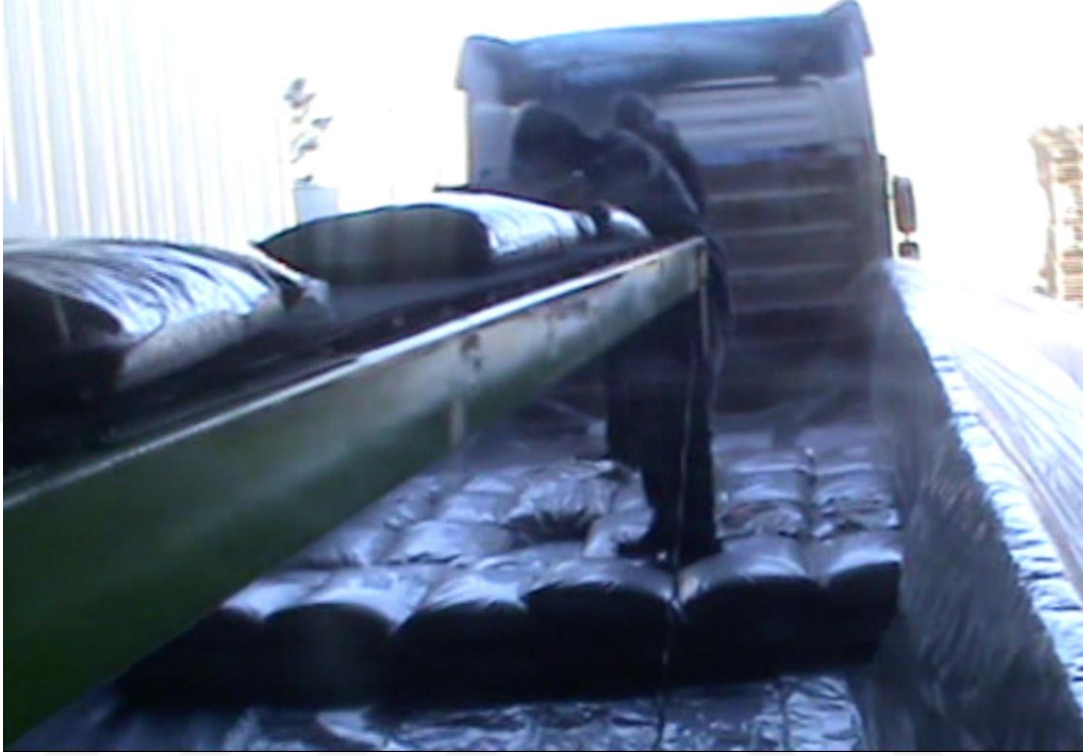
Görsel 4. 17: uvalların treylere indirilmesi
