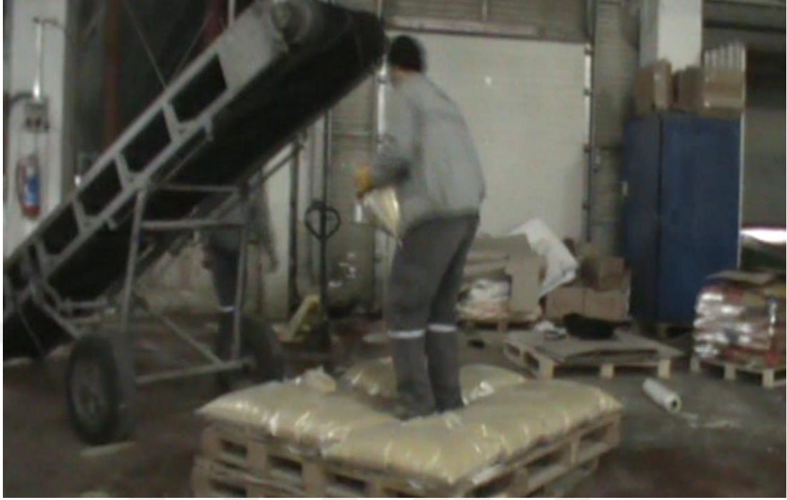
Görsel 4. 9: Çuvalın palete yüklenmesi
