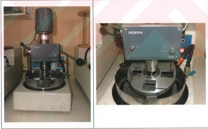
Şekil 4.3. Bölümde bulunan ve PEDEPIN otomatik parlatma kafası ile modifiye edilmiş Metkon GRIPO 200-1 zımparalama ve parlatma cihazı.
