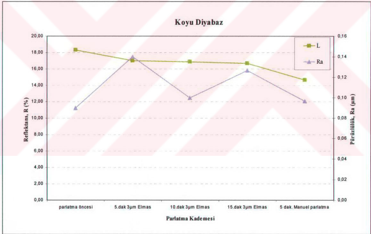
Şekil 4.26. UDDP ile parlatılmış koyu renkli diyabaz numunesinde pürüzlülük ve parlaklık değerlerinin parlatma kademesi ile değişimi.
