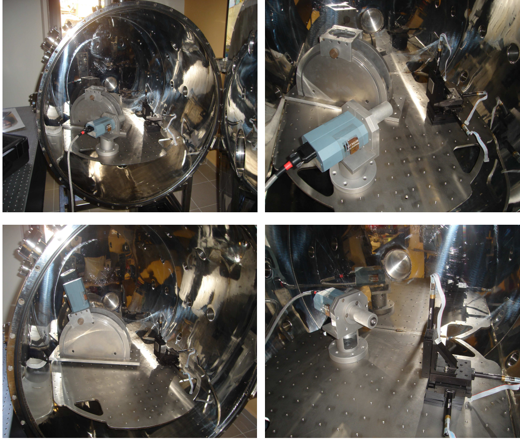
Şekil 5.15: Vakum hücresi içine yerleştirilen pinhole kamera ve kristal spektrometre (Kocaeli Üniversitesi - Lazer Teknolojileri Araştırma ve Uygulama Merkezi, 2006).
