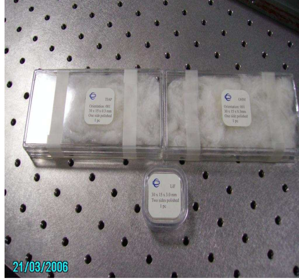
Şekil 4.2: Kristal spektrometrede kullanılan kristaller.
