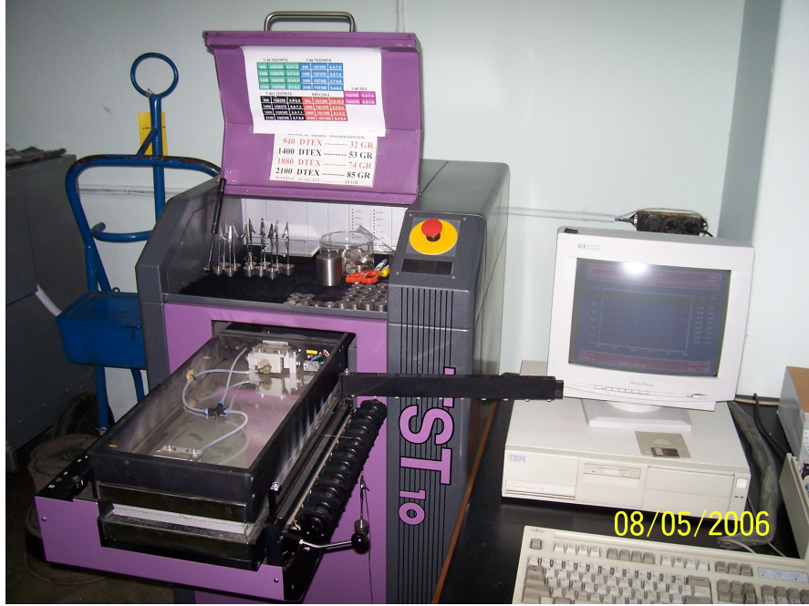
Şekil 5.6: Isıl kısılma cihazı
