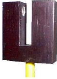
Şekil 4.16: Kopuk lif sayıcısı
