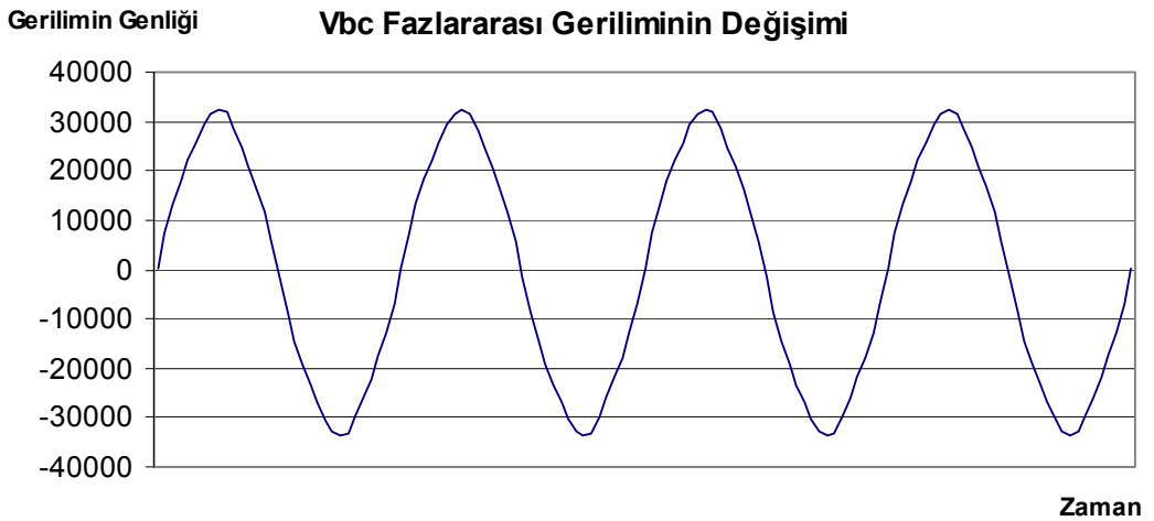
Şekil 4.29: Demir işletmesinde 4 Nisan günü 11:59:29’deki data kaydında bulunan arızalı kısım
