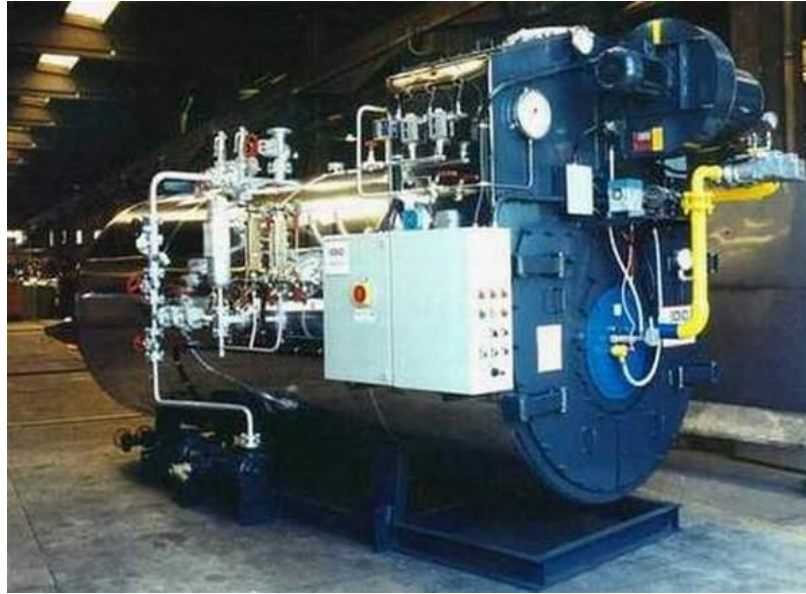
Şekil 3.3: Çeşitli sektörlerde kullanılan tam donanımlı skoç tipi buhar kazanı
