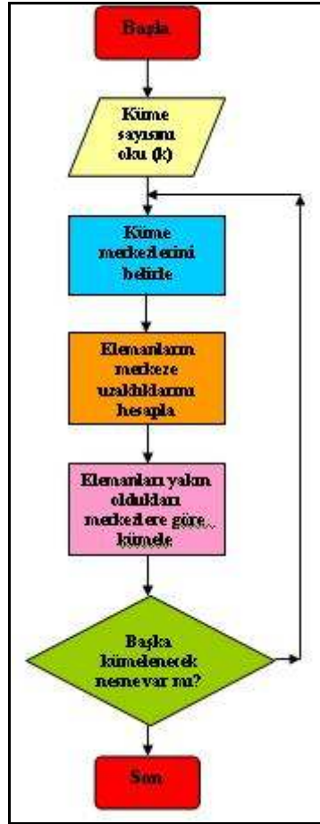
Şekil.4.2 K-means algoritmasının adımları.
