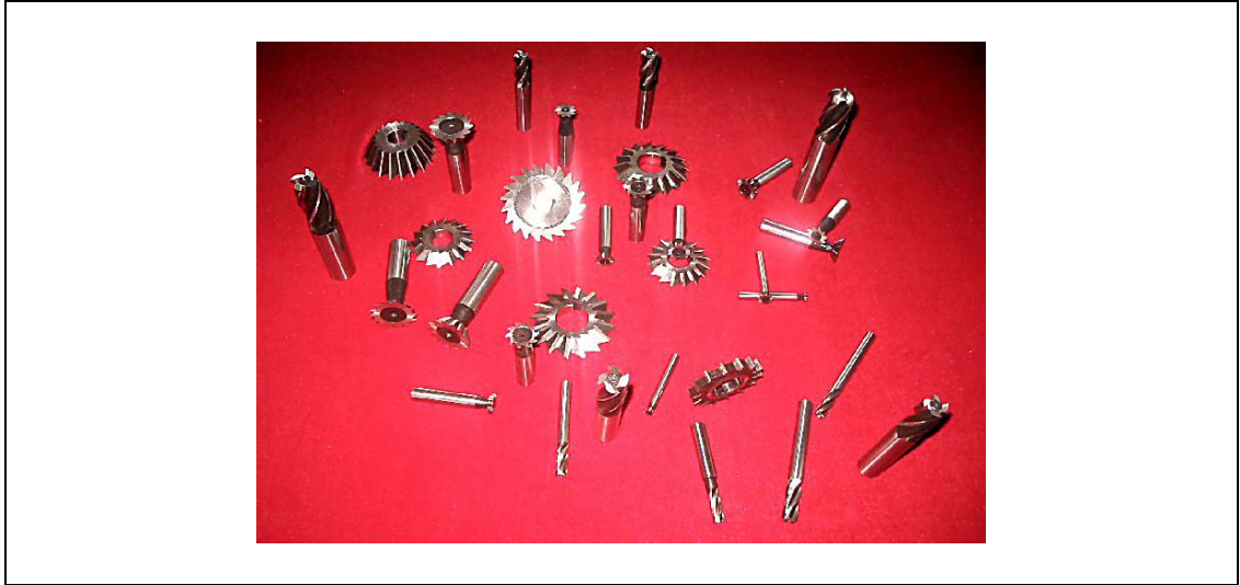
Şekil 3.11. Döküm yolu ile 7. Bakım Merkezi, Tuzla'da üretilen HSS takımlardan bir kesit.
