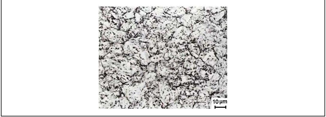
Şekil 2.4. AISI H13.(DIN 1.2344) Kromlu sıcak iş takım çelikleri. 1025°C (1875°F)'ye kadar ısıtılmış, havada soğutulmuş ve 595 °C (1100°F)'de iki kez menevişleme yapılmış. 42 HRC. Yapı martenzit ve az miktarda çözünmemiş ince karbür. % 2 nital. (C: 0.32-0.45, Mn: 0.20-0.50, Si: 0.80-1.20, Cr: 4.75-5.50, Ni: 0.30max., Mo: 1.10-1.75, V: 0.80-1.20) [5].
