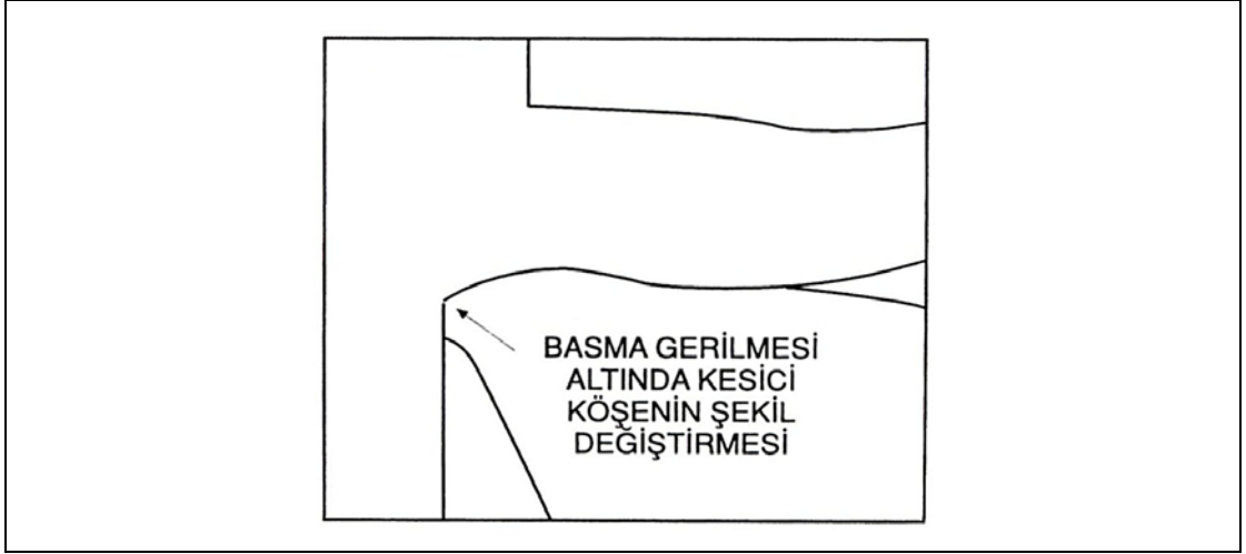
Şekil 4.15. Kesici köşede plastik deformasyon [4].
