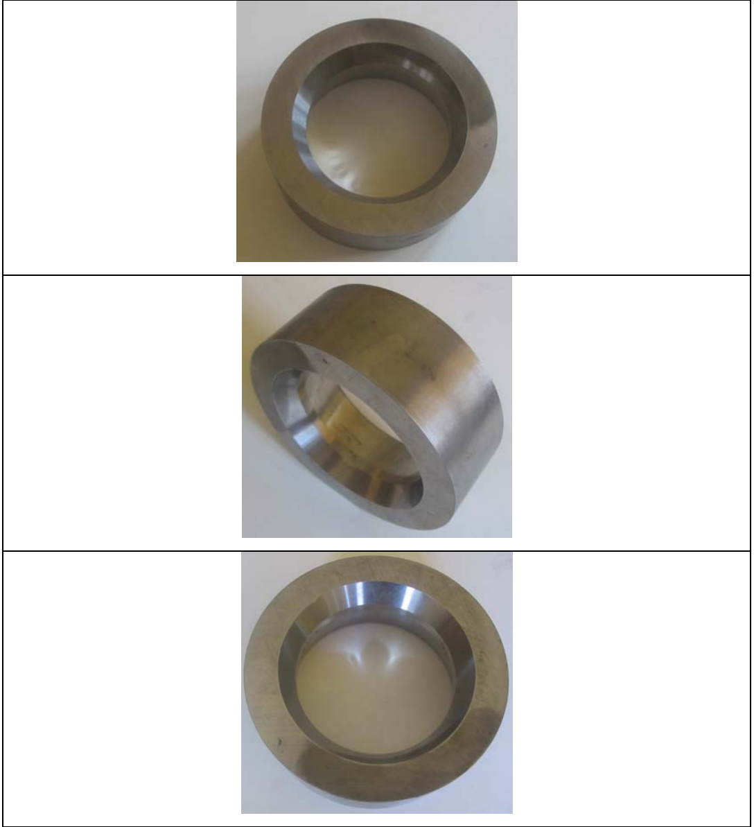
Şekil 5.93. Borlu yüksek hız takım çeliğinden üretilen boru haddeleri.
