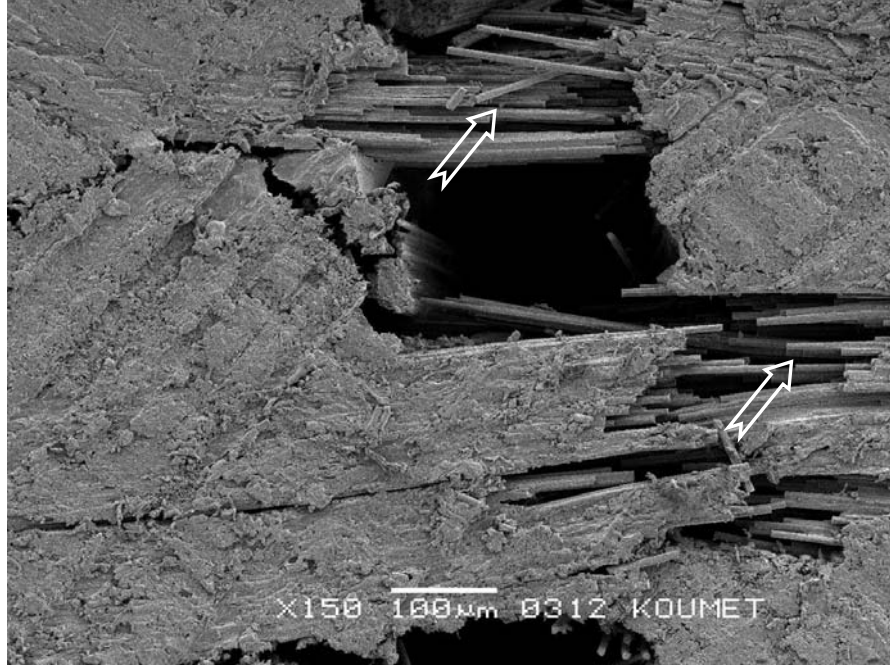
Şekil 4.78: 100 kere termal çevrime tabi tutulmuş [(0^\circ/90^\circ)]_{4s} yönlenme düzenine sahip sürekli cam fiber takviyeli PEI matrisli numunenin fiber/matris ara yüzey mukavemetini ifade eden TEM görüntüsü
