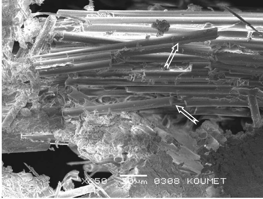
Şekil 4.73: 100 kere termal çevrime tabi tutulmuş numunenin fiber/matris ara yüzey mukavemetini ifade eden TEM görüntüsü
