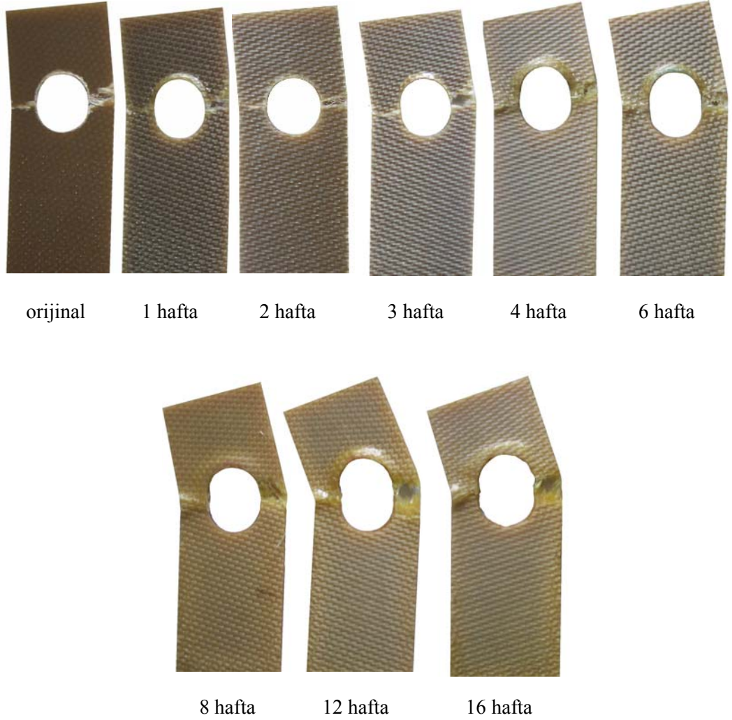
Şekil 4.38: %37'lik hidroklorik asit çözeltisinde bekletilen malzemelerin renk değişimi
