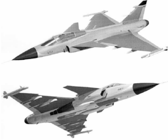
Şekil 1.1: İsveç hava kuvvetlerine ait JAS39 tipi uçaktaki kompozit yapılar koyu gri renk ile belirtilmiştir (Schön ve Nyman, 2002)
