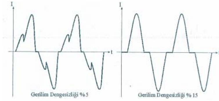
Şekil 2.6: Kaynak sistemi dengesizken üç faz diyot doğrultucuların hat akım dalga biçimleri (Atasal,M.,2000)
