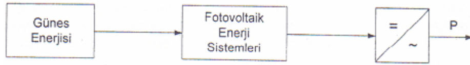
Şekil 4.6: Fotovoltaik enerji üretimi blok şeması(Kocatepe,C.,Pr.Dr.,2005)
