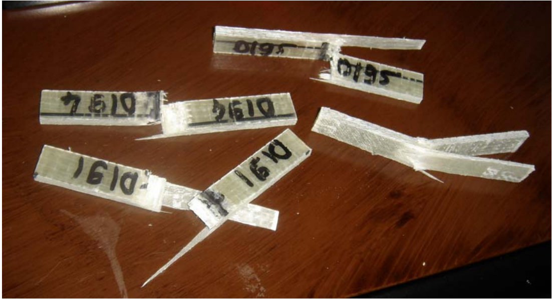
Şekil 5.54: İnfüzyon yöntemiyle elde edilmiş parçaların darbe deneyi sonrası delamine olmuş görünüşleri
