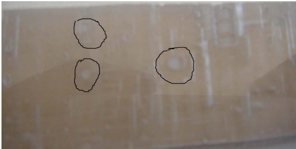
Şekil 5.3: El yatırması ürünlerde gözlenen hava boşlukları
