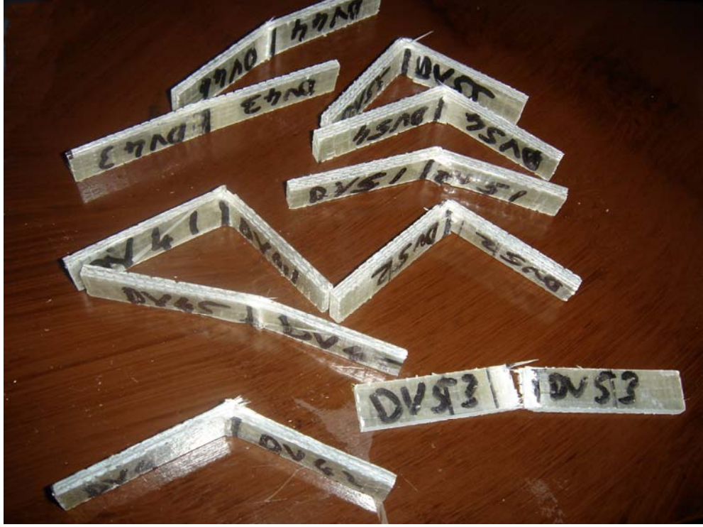
Şekil 5.51: Vakum yöntemiyle üretilmiş parçaların darbe deneyi sonrası görünüşleri
