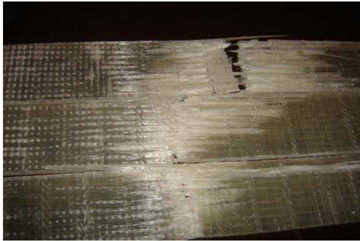
Şekil 5.44: 6 nolu parçaların kırılma şekilleri
