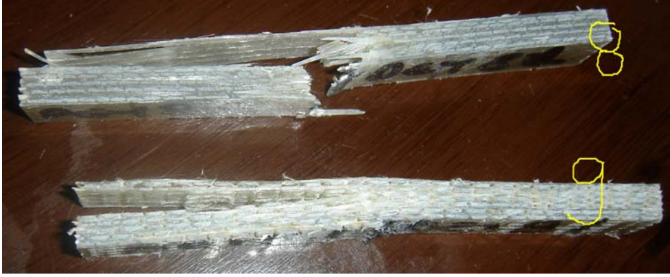
Şekil 5.49: El yatırması yöntemiyle üretilmiş 8 ve 9 no'lu parçaların darbe deneyi sonrası
