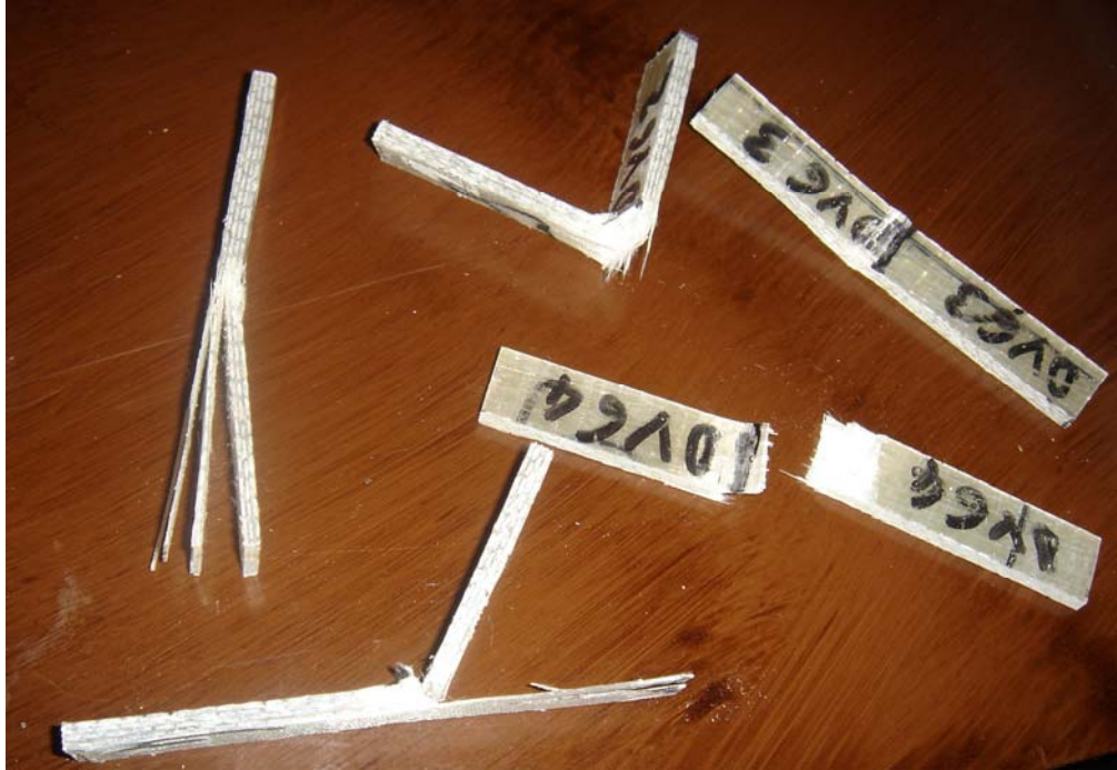
Şekil 5.52: Vakum yöntemiyle üretilmiş parçaların darbe deneyi sonrası delaminasyona uğramış örnekleri
