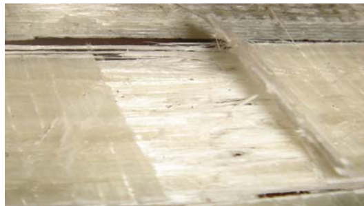
Şekil 5.42: 8. nolu parçada matris kabuk gibi kalkmış ve altında ıslanmamış elyaflar gözükmektedir.
