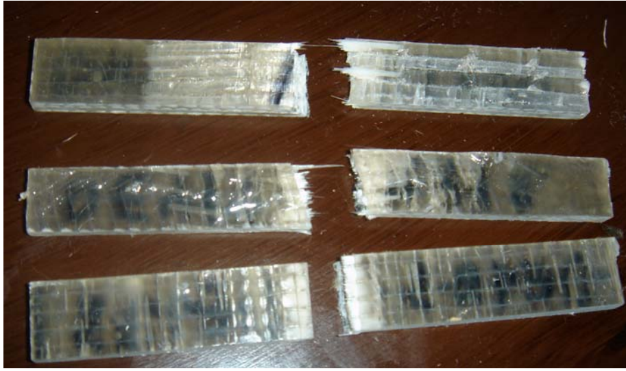
Şekil 5.50: El yatırması yöntemiyle yapılan parçaların darbe deneyi sonrası kopmuş durumları
