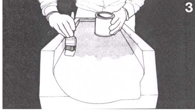
Şekil 3.3: Jelkot reçinesinin sürülmesi
