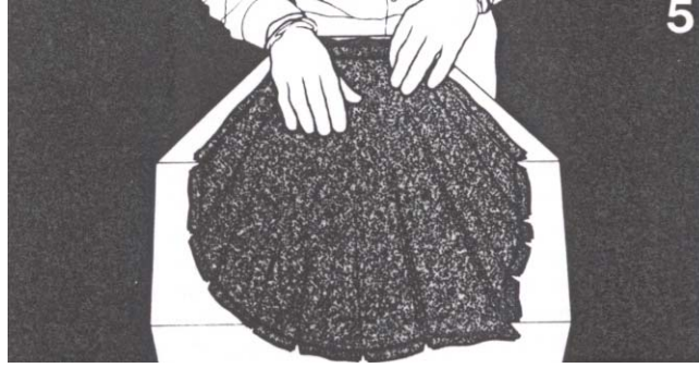
Şekil 3.5: Elyafın ilk katı ıslak kalıp yüzeyine yatırılır
