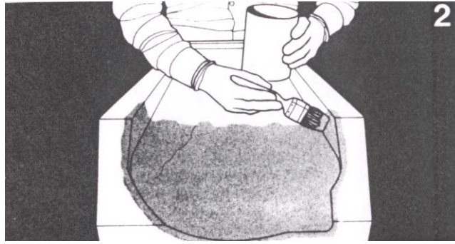
Şekil 3.2: Kalıp ayırıcının uygulanması
