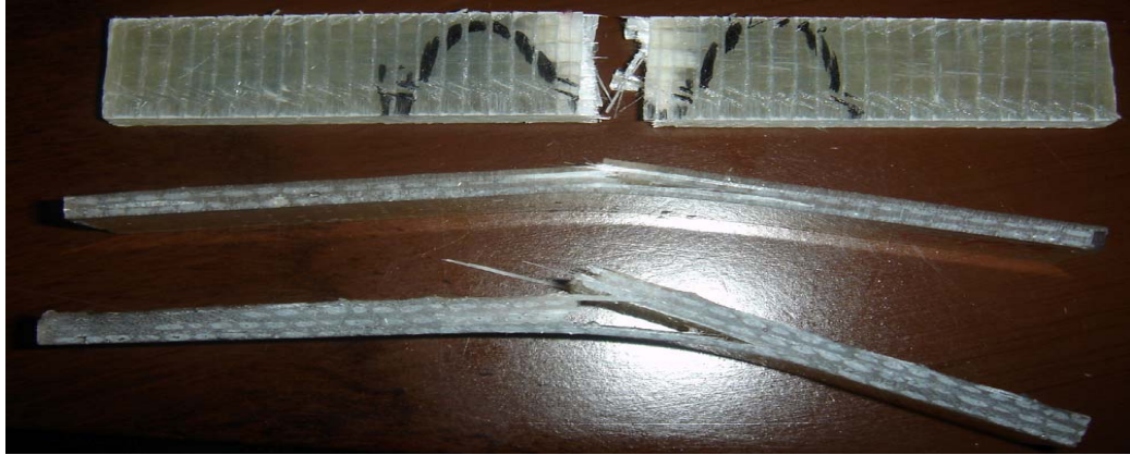
Şekil 5.56: Eğme deneyi uygulanmış el yatırması numuneleri
