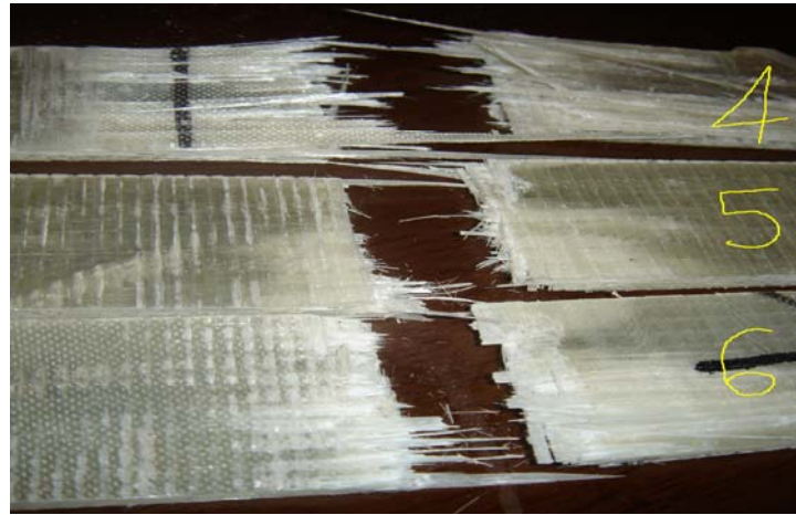
Şekil 5.46: Vakumla üretilmiş 4,5 ve 6. parçaların çekme testi sonrası
