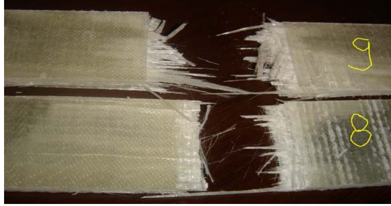
Şekil 5.47: İnfüzyonla üretilmiş 8 ve 9 no'lu parçaların çekme deneyi sonrası görünüşü
