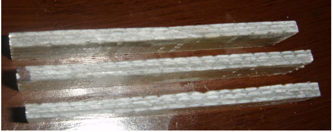
Şekil 5.8: Vakum yöntemiyle elde edilmiş parçaların kesitleri
