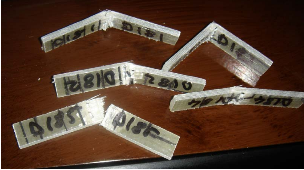
Şekil 5.53: İnfüzyon yöntemiyle üretilmiş parçaların darbe deneyi sonrası görünüşleri
