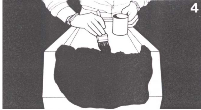
Şekil 3.4: Laminasyon reçinesi kalıba bolca sürülür
