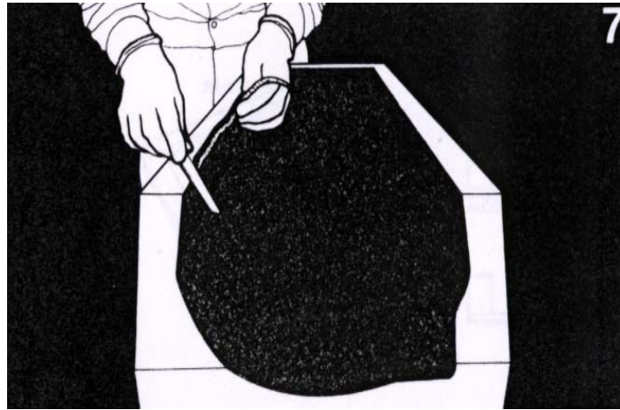
Şekil 3.7: Laminasyon bittikten sonra kenarlara taşmış reçine hala jelleşmemişken keskin bir bıçak ile alınabilir
