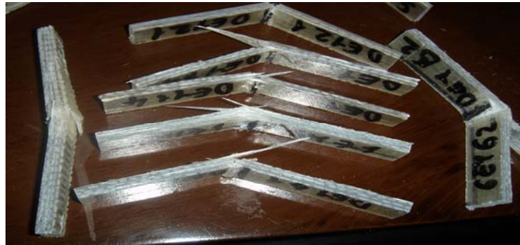
Şekil 5.48: El yatırması yöntemiyle üretilmiş parçaların darbe deneyi sonrası
