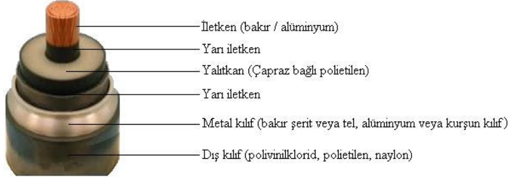
Şekil 3.1: Bir yeraltı güç kablosunun katman katman görünüşü
