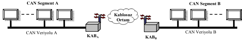
Şekil 5.4: KAB’ın kullanıldığı örnek bir endüstriyel ağ
