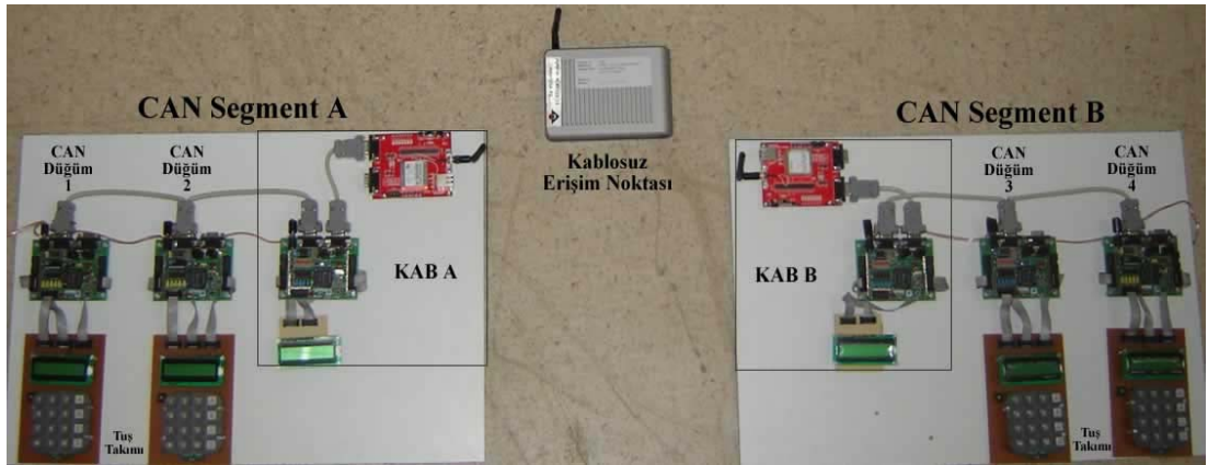
Şekil 6.5: KAB'ın kullanıldığı endüstriyel ağ uygulaması
