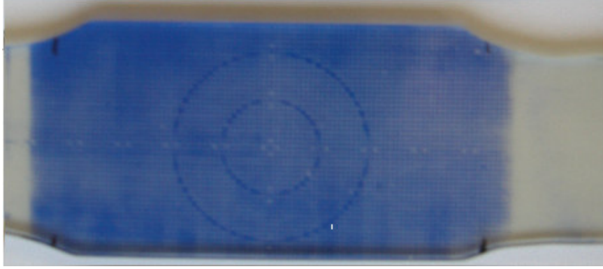
Şekil 5.25. Tek yönlü çekme için hazırlanmış PVC örnek ( \lambda=1.0 ).
