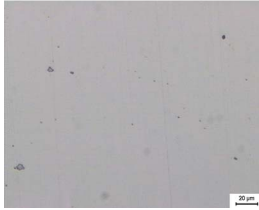
Şekil 7.21. Orijinal Alman zırh çeliğine ait parlatılmış konumda mikroyapı. Yapıda değişik morfolojilerde karbürler yer almaktadır, IM.
