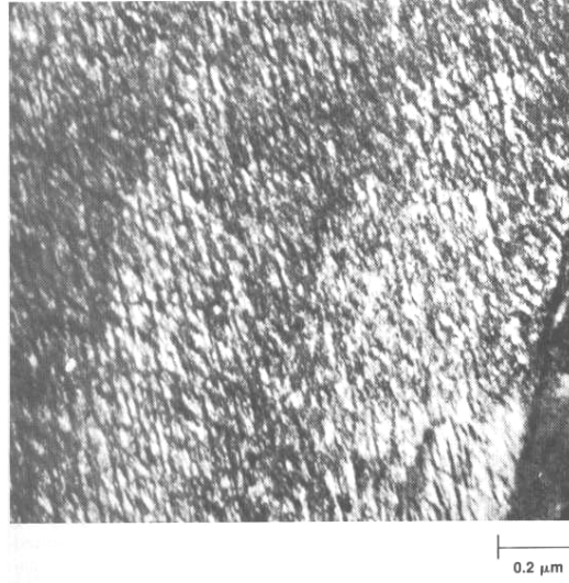
Şekil 4.2. 150°C' temperlenen Fe-1.22C alaşımında ince plaka tipi martenzitin yapısında geçiş karbürlerinin etkisini gösteren transmisyon elektron mikroskop görüntüsü [2].
