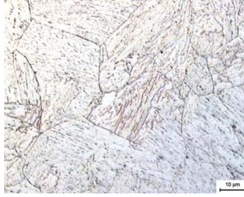
Şekil 7.27. Birinci deneysel zırh çeliği kompozisyonuna sahip çeliğin 1000 °C, 60 dak. /600 °C, 60 dak. ısıl işlemlenmesi sonrası oluşturulan yapıya ait enterferans kontrast görüntüsü. Nital ile dağlama, IM.
