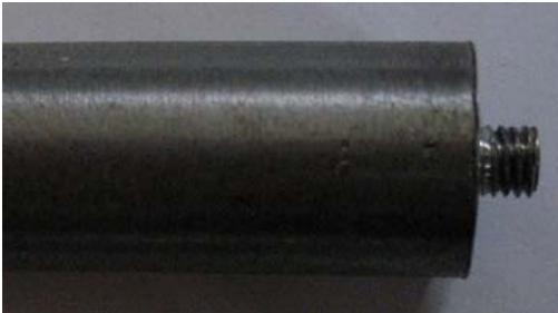
Şekil 3.4: Tek taraflı sürtünme karıştırma kaynak işlemi sırasında kullanılan takım ucu
