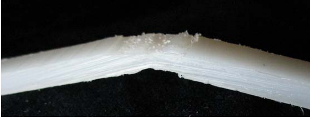
Şekil 4.19: Çift taraflı SKK ile birleştirilmiş bir numunede yüz eğme deneyi sonucu kırılmayan numune
