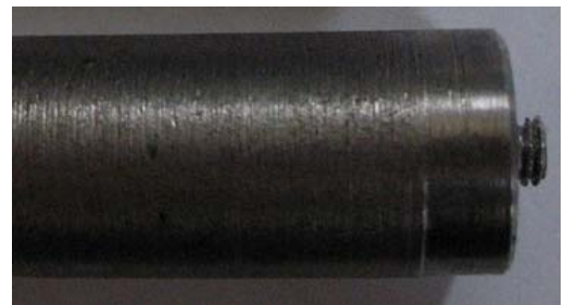
Şekil 3.5: Çift taraflı sürtünme karıştırma kaynak işlemi sırasında kullanılan takım ucu
