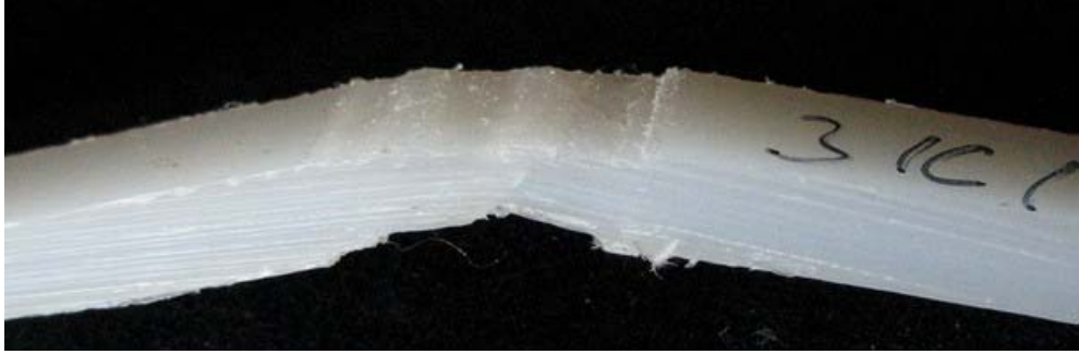
Şekil 4.20: Çift taraflı SKK ile birleştirilmiş bir numunede kök eğme deneyi sonucu kırılmayan numune
