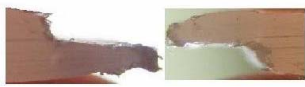
Şekil 4.15: Şekil 4.14'te verilen tipte bir bağlantı için kopma durumu ("5C" kodlu numune)
