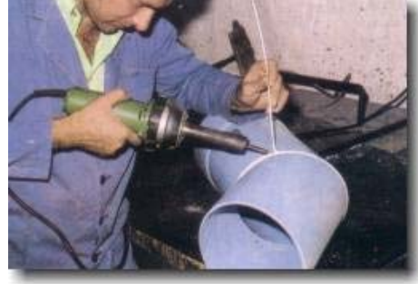
Şekil 2.4: Sıcak gaz kaynağının uygulaması (Joshi)
