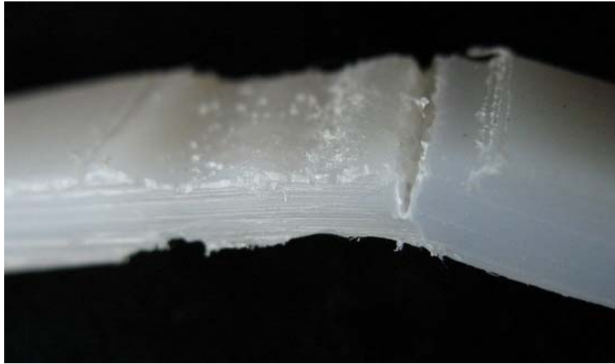
Şekil 4.21: Çift taraflı SKK ile birleştirilmiş bir numunede yüz eğme deneyi sonucu kırılan numune
