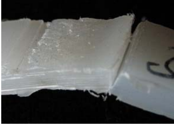
Şekil 4.22: Çift taraflı SKK ile birleştirilmiş bir numunede kök eğme deneyi sonucu kırılan numune
