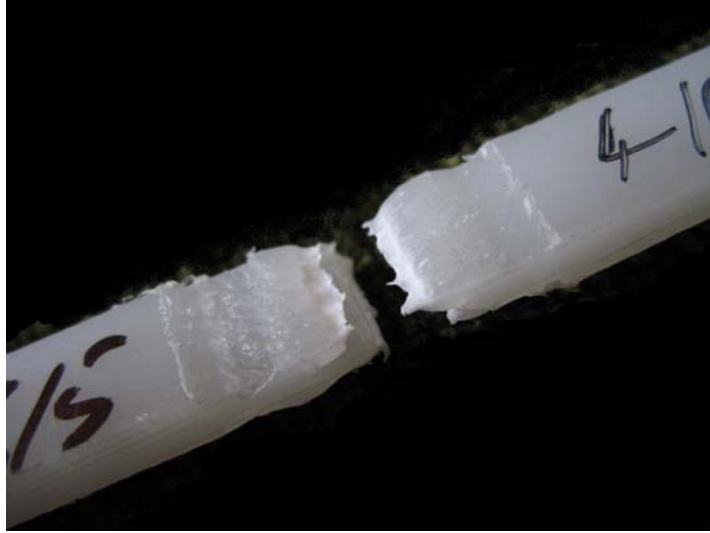
Şekil 4.18: Çift taraflı SKK ile birleştirilmiş bir numunede çekme deneyi sonucu oluşan kopma
