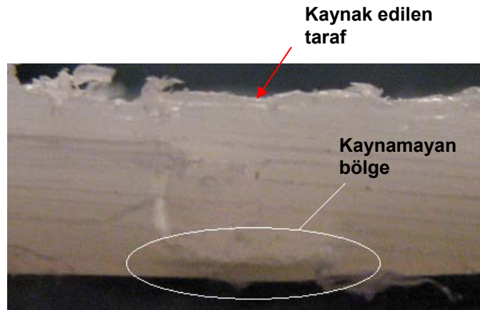
Şekil 4.1: Tek taraflı sürtünme karıştırma kaynağının etkilediği bölge
