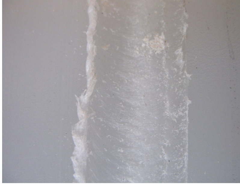
Şekil 4.49: Takım omzunun kaynak bölgesinde malzeme yığıldığı durum
