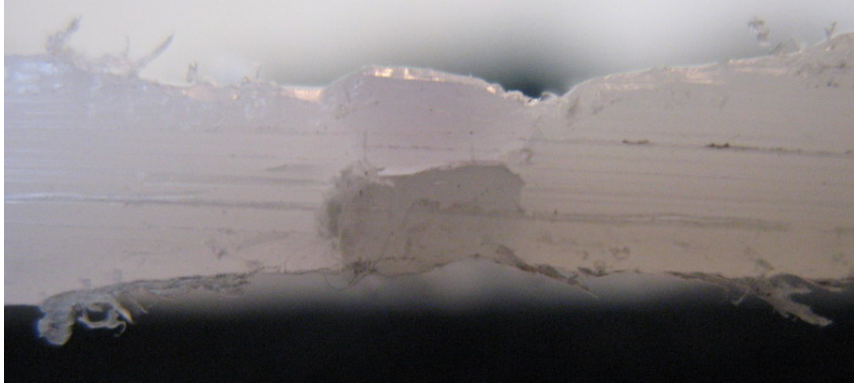
Şekil 4.14: Kötü bir çift taraflı SKK bağlantısı ("5C" kodlu numune)
