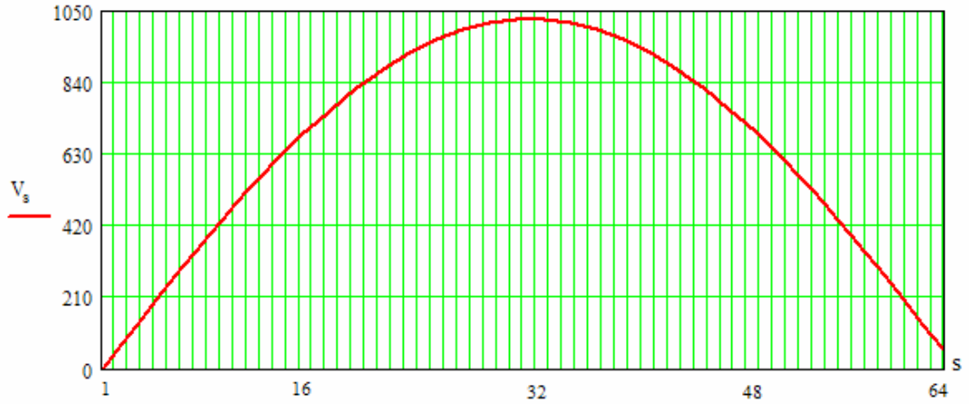
Şekil 10.3: Bir periyotta mikrodenetleyici tarafından örneklenen gerilim
