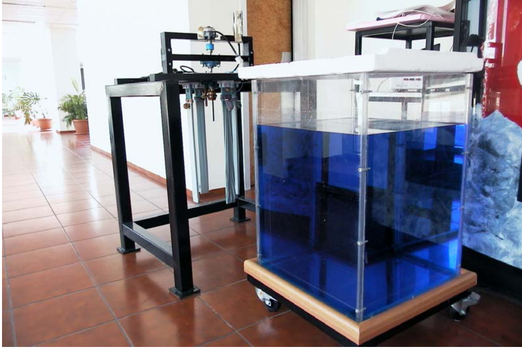
Şekil 5.6: UME’de kurulan bakır kaplama havuzu
