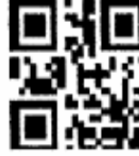
Şekil 4.19. 4 düzeyinde korumalı QR kodu (Osman ve Furness, 2000).
