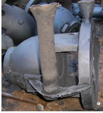
Şekil 10.14(Devam): Pompa rulman taşıyıcı gövdenin döküm sonrası resimleri
