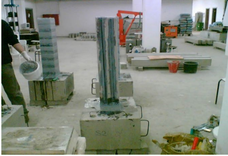
Şekil 3.10: Karbon ve cam elyaf sargılama işlemi
