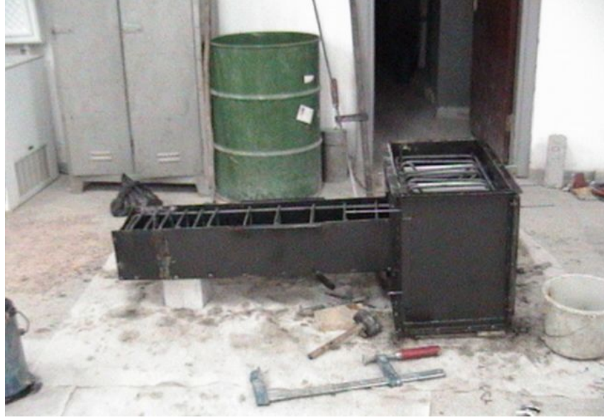
Şekil 3.9: Numune kalıbı ve donatı yerleşimi
