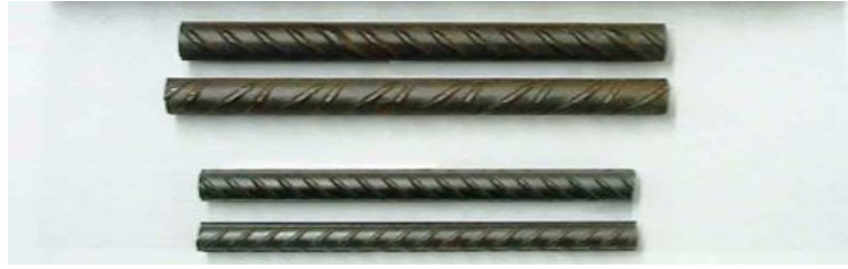
Şekil 3.1: Kullanılan donatıların nervür geometrisi
