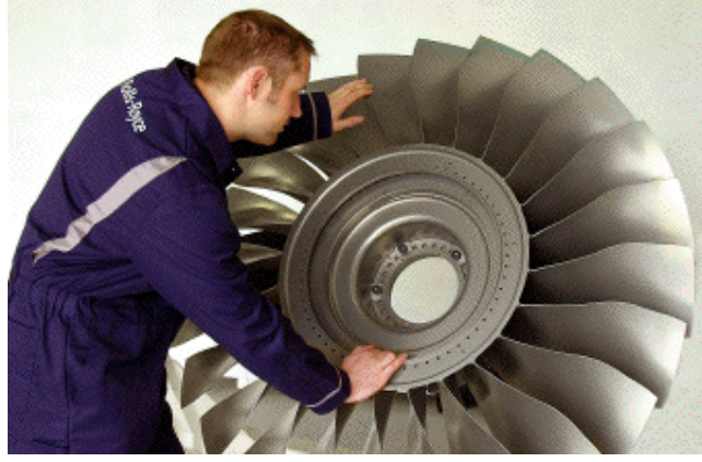
Şekil 3.5: Rolls Royce uçak motorunun Ti6Al4V' dan imal edilmiş türbin kanatları
