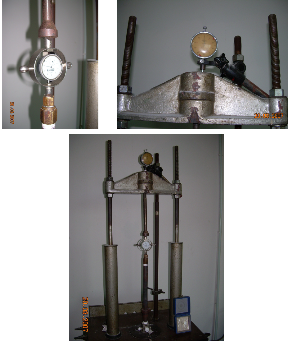
Şekil 4.6: Ölçme saati ve dinamometre ile kuvvet kalibrasyonu
