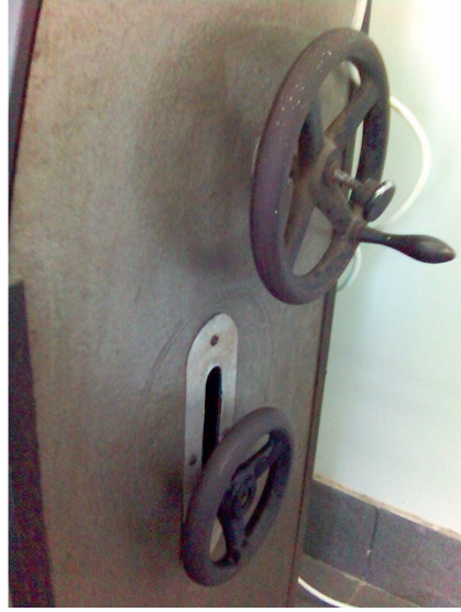
Şekil 4.5: Baskı kuvvetini sađlayan sonsuz vida mekanizması mekanik kontrol kolları
