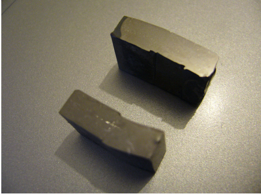
Şekil 6.4: Birleştirilen numunelerin sertlik ölçümleri sonrası görüntüleri
