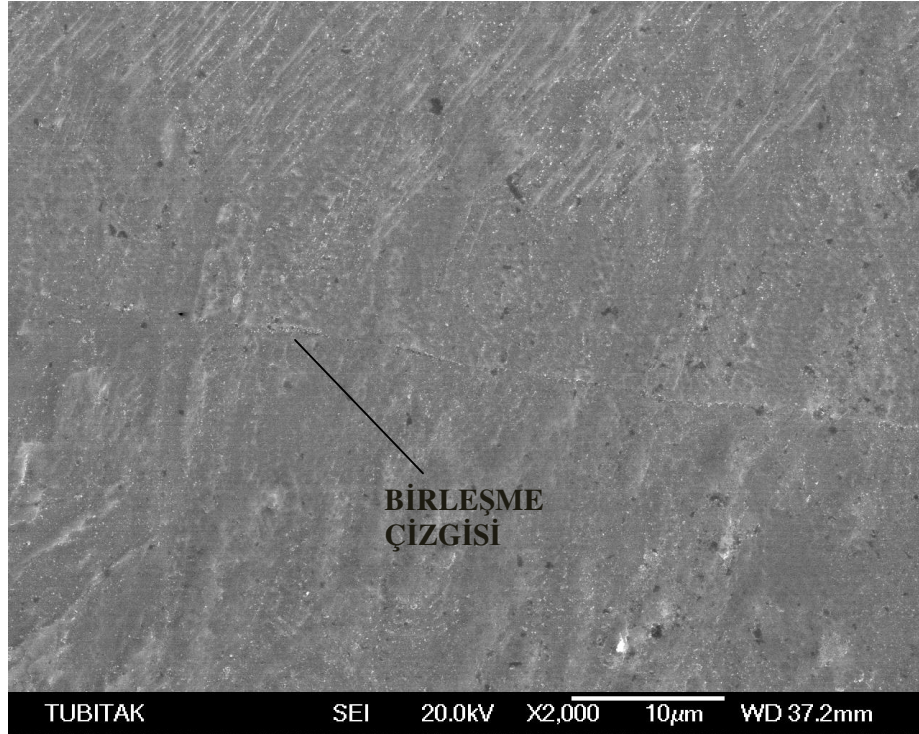
Şekil 6.29: 655°C – 2,72Mpa – 60 Dak. parametreleri ile kaynatılan numunenin SEM görüntüsü
