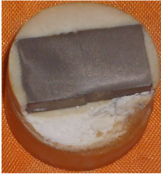
Şekil 6.1: Difüzyon kaynağı sonrası numunelerin bakalit içine alınmış görüntüsü
