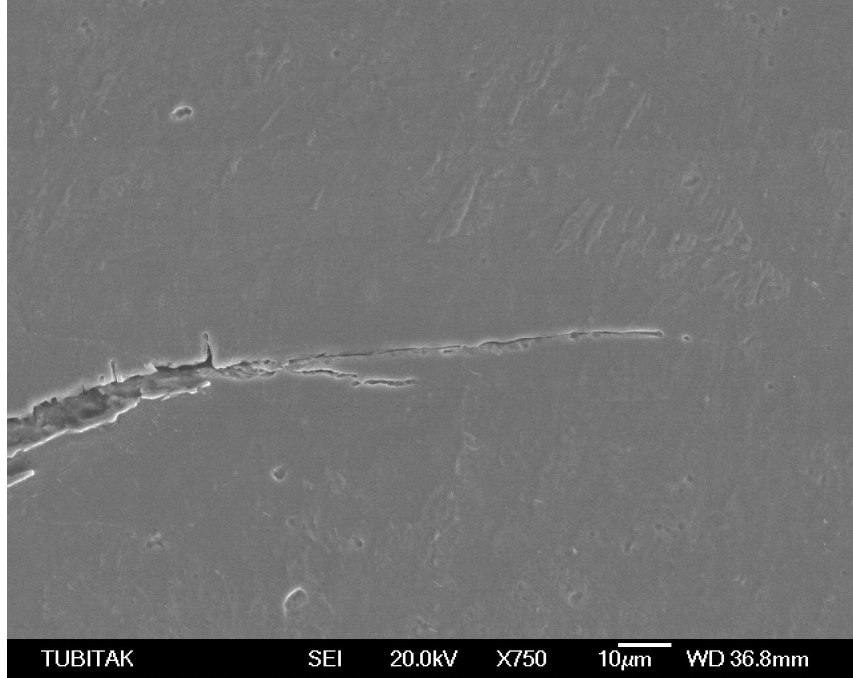
Şekil 6.27: 600°C – 2,72Mpa – 60 Dak. parametrelerinde birleşmenin gerçekleşmediği numunede kırılma yüzeyinin SEM görüntüsü
