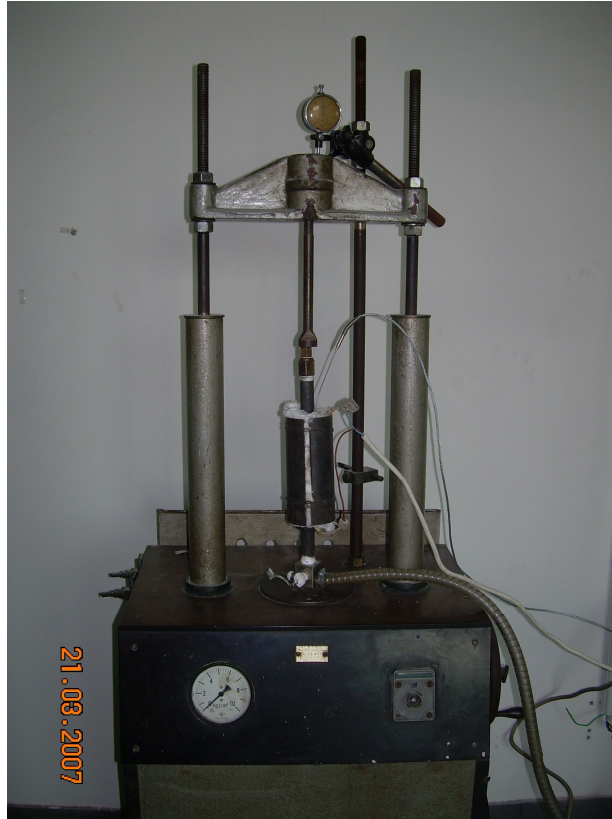
Şekil 4.4: Deneylerde kullanılan difüzyon kaynağı teçhizatı
