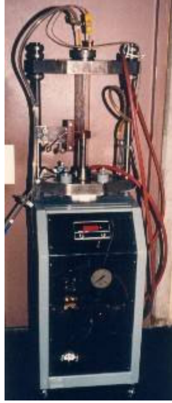
Şekil 2.14: Hidrolik basınç sistemine sahip komplike bir difüzyon kaynağı makinesi
