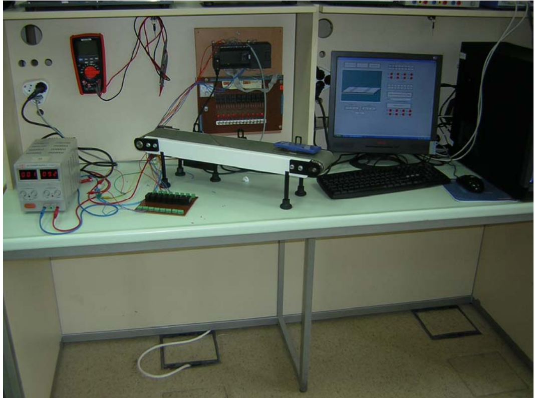
Şekil 4.25: Laboratuvar ortamında oluşturulan model taşıyıcı uygulama prototipi
