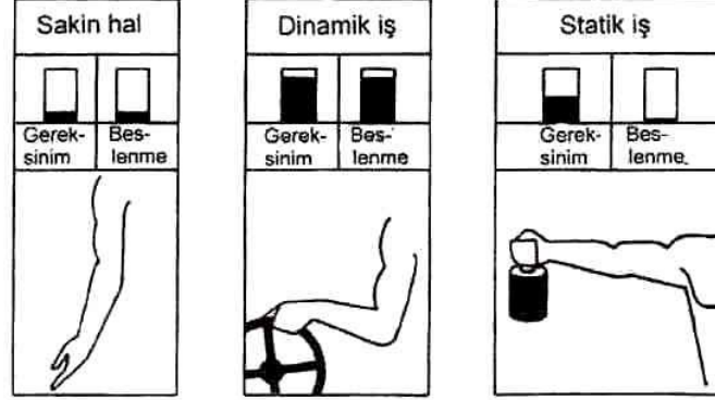
Şekil 2.2: Statik hal, statik kassal çalışma ve dinamik kassal çalışmada kaslardaki kan dolaşımı ve kan gereksinimi (Babalık, 2005)
