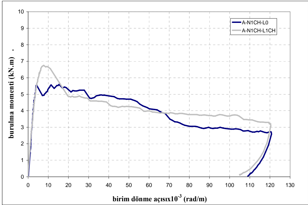
Şekil 5.5: A-N1CH-L0 ve A-N1CH-L1CH numunelerine ait burulma momenti – birim dönme açısı grafikleri
