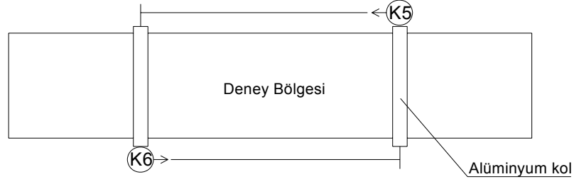
Şekil 4.19: Toplam boy uzamanın belirlenmesi amacıyla kullanılan 2 elektronik komparatörlerin yerleşimi (numunenin yandan görünüşü)
