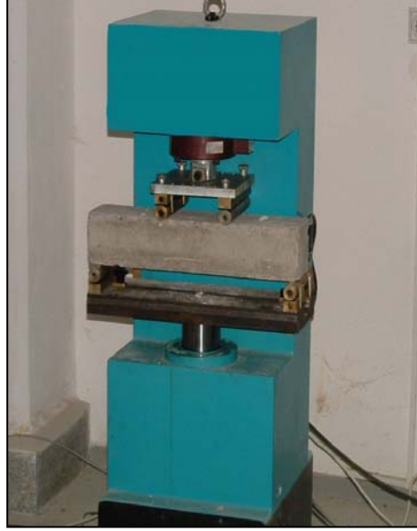
Şekil 4.14: Beton kiriş eğilme deneyi
