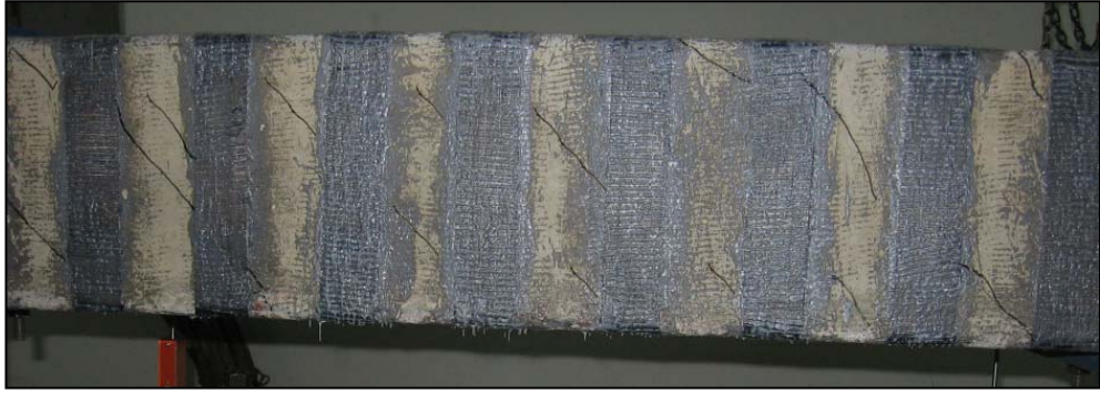
Şekil 6.3: A-N1CN-L0 numunesinin \theta=0.10 rad/m anındaki çatlak dağılımı
