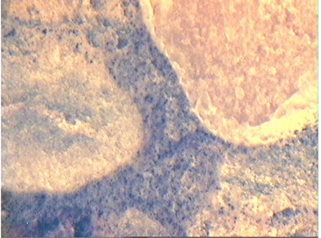
Şekil F.6: 200 kPa basınç ile enjeksiyon edilmiş numunenin 50x fotoğrafı
