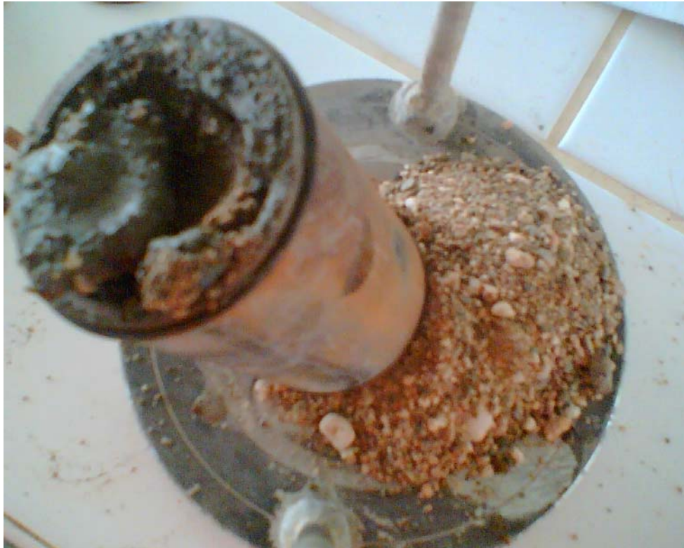
Şekil 5.5: Deneme enjeksiyonlarında başarısız olan numune
