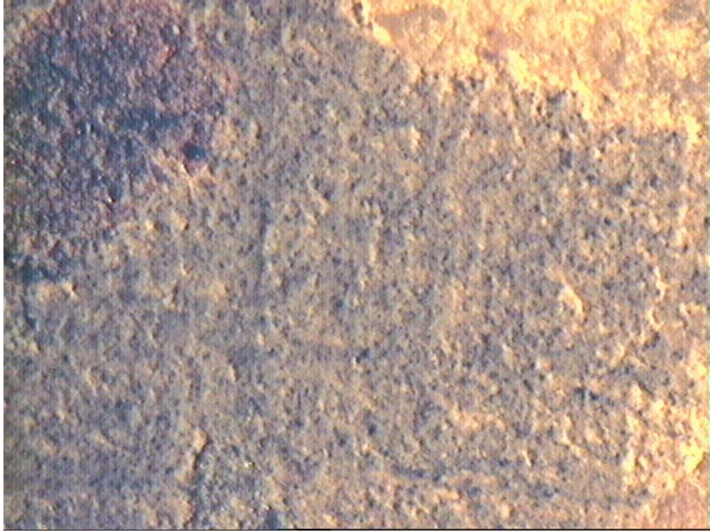
Şekil F.3: 150 kPa basınç ile enjeksiyon edilmiş numunenin 50x fotoğrafı
