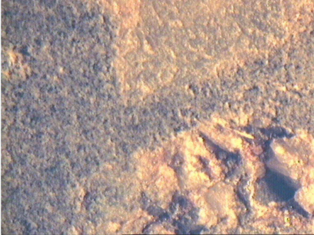
Şekil F.4: 150 kPa basınç ile enjeksiyon edilmiş numunenin 50x fotoğrafı
