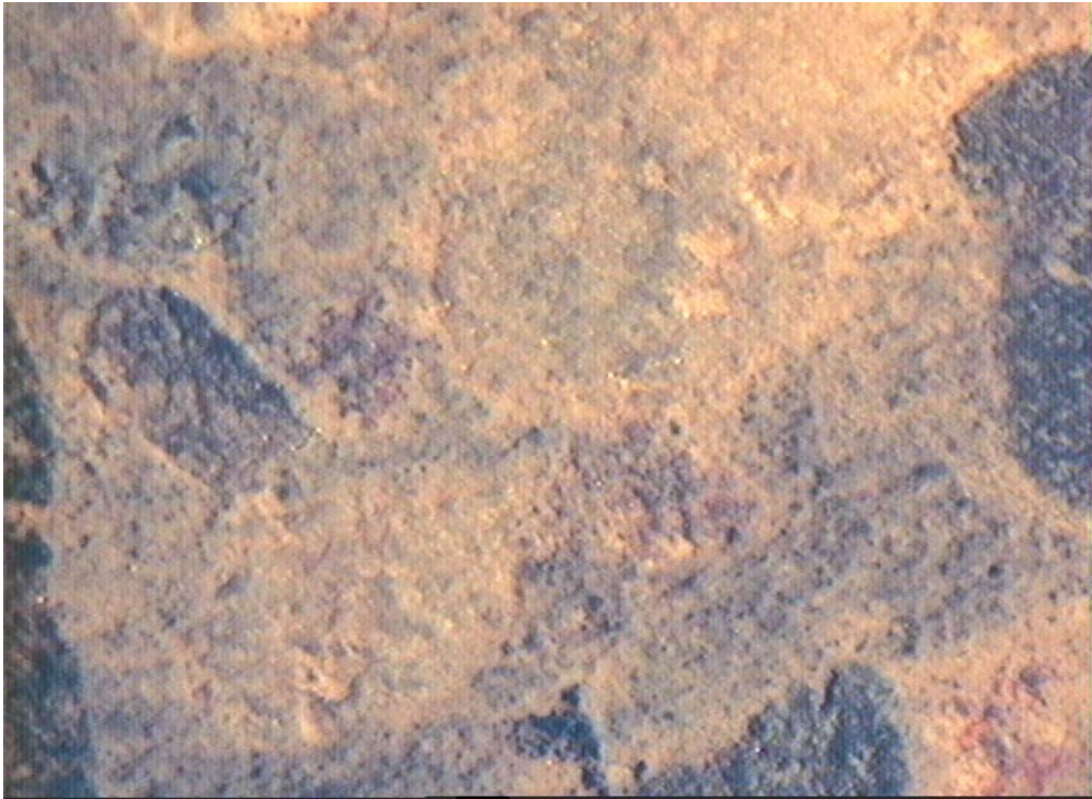
Şekil F.2: 100 kPa basınç ile enjeksiyon edilmiş numunenin 50x fotoğrafı
