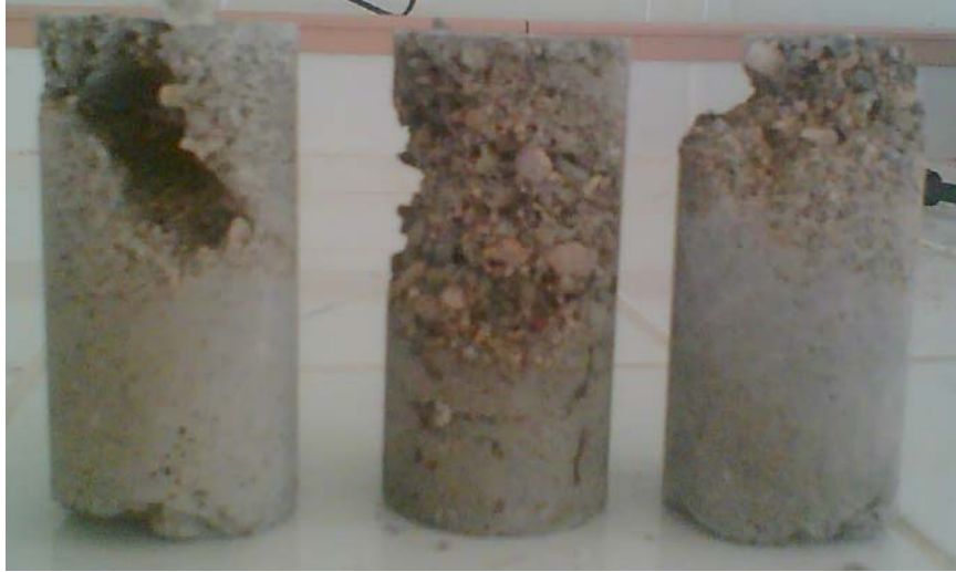
Şekil 5.8: Enjeksiyon uygulaması başarısız olan numuneler
