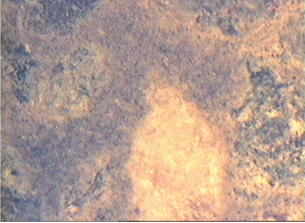
Şekil F.1: 100 kPa basınç ile enjeksiyon edilmiş numunenin 50x fotoğrafı
