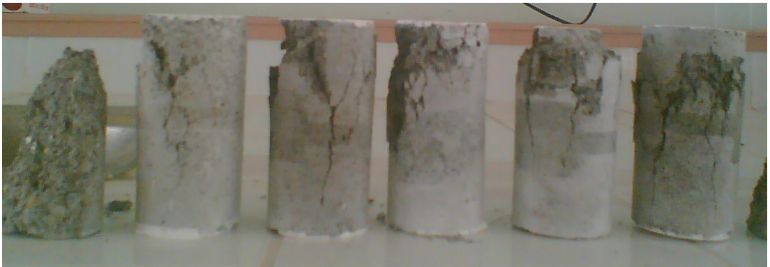
Şekil 5.30: Serbest basınç deneyi yapılmış numuneler
