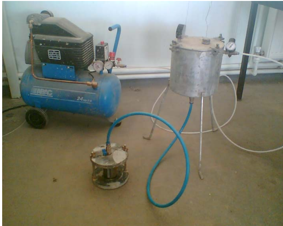
Şekil 5.3: Enjeksiyon deney düzeneği
