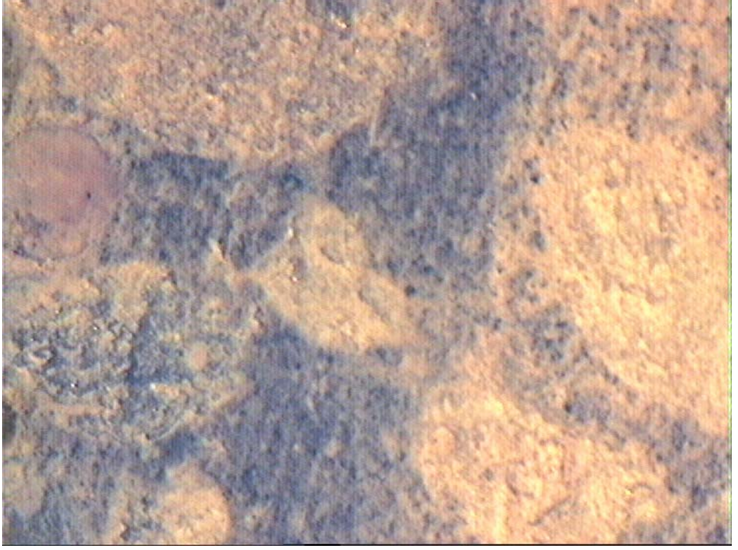
Şekil F.5: 200 kPa basınç ile enjeksiyon edilmiş numunenin 50x fotoğrafı
