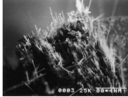
Şekil 2.5: Cam fiber takviyeli polimerde fiber soyulmasının SEM resmi (Roy ve diğ., 2001)
