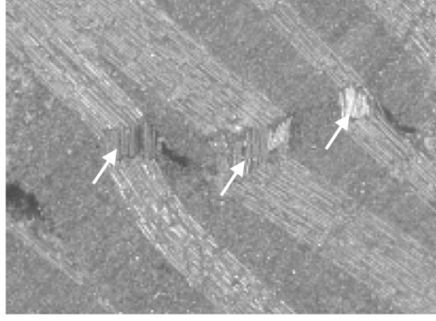
Şekil 2.10: Basma yüklemesi nedeniyle oluşan burkulma bantları (Rakow ve Pettinger, 2006)
