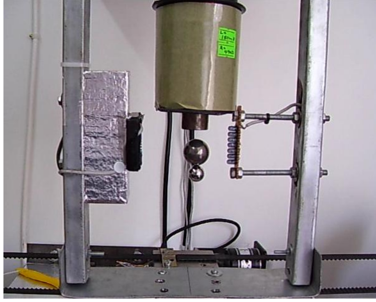
Şekil 5.36 : Manyetik süspansiyon sisteminin 25mm ve 16mm çaplarında iki bilye ile birlikte yatay ekseninde hareket eden düzeneğe monte edilmesiyle oluşan deney düzeneği
