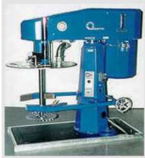
Şekil 2.9: Yüksek hızlı karıştırıcı ve dağılım bıçağı (Niemann, 2007)
