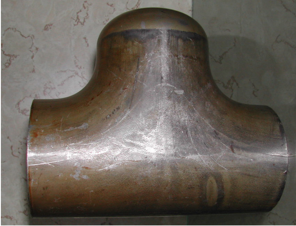
Şekil 3.1: Hydroforming yöntemiyle üretimi tasarlanan “T” bağlantı elemanı
