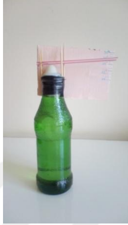
Şekil 4. 3.On dakika içerisinde sıcaklık ölçümü yapabilen termometre ortaokul öğrencisi tasarımı (örnek 73)
