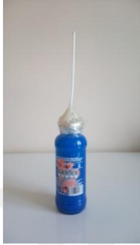
Şekil 4. 1.Ölçüm aralıksız tasarlanan termometreler (solda gönüllü ortaokul öğrencisi örnek 47, sağda gönüllü öğretmen adayı örnek 1)
