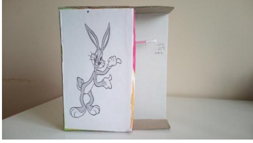
Şekil 4. 5. Sabit basınçtaki bir gazın hacim değişikliği ilkesi ile çalışan termometre gönüllü ortaokul öğrencisi (örnek 72)
