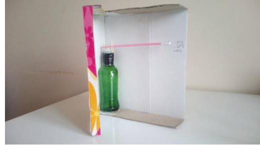
Şekil 4. 5. Sabit basınçtaki bir gazın hacim değişikliği ilkesi ile çalışan termometre gönüllü ortaokul öğrencisi (örnek 72)
