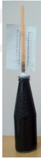
Şekil 4. 2.Birden çok ölçüm yapabilen termometre (örnek 27)
