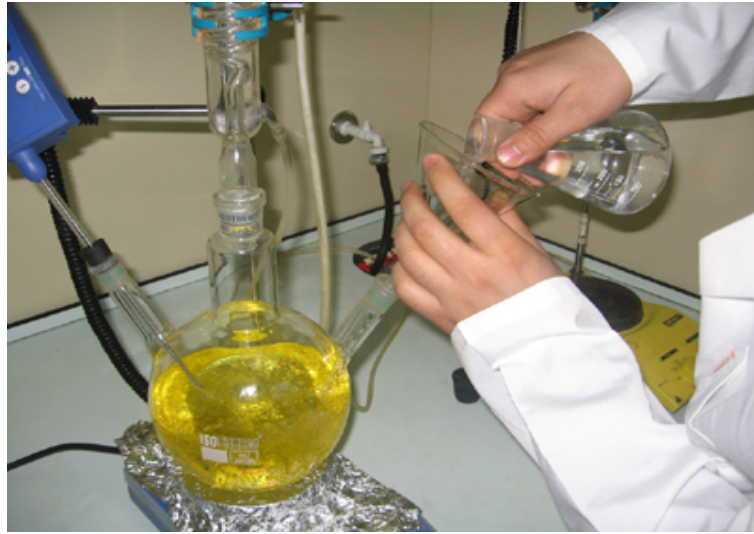
Şekil 5.8: Alkol-Katalizör Karışımının Reaksiyon Kabına Eklenmesi
