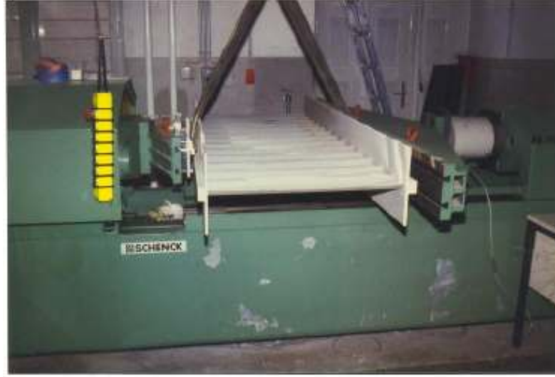
Şekil 4.19: İlk 3 deneyde kullanılan kiriş numunelerinde yapılan destekler
