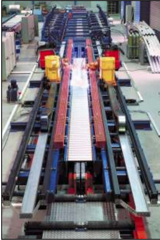
Şekil 4.2: Sin Profil Üretiminde Kaynak Ünitesi
