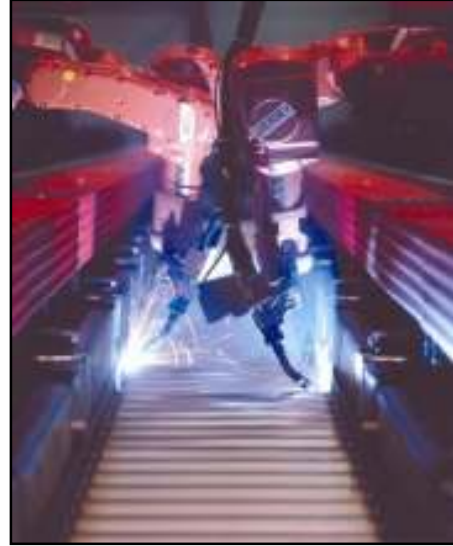
Şekil 4.2: Sin Profil Üretiminde Kaynak Ünitesi
