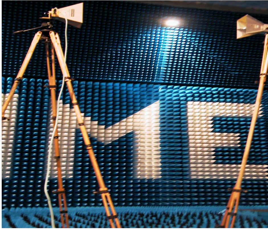
Şekil 5.3: İki anten metodu deney düzeneği
