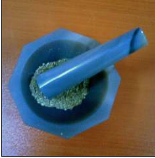
Şekil 3.9: Kurutulmuş örneklerin toz haline getirilmesi
