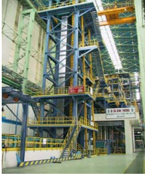
Şekil 6.3: Sürekli galvanizleme hattı
