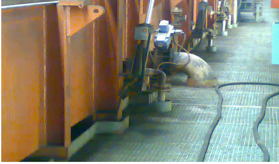
Şekil 6.7: Asit kirlendiğinde otomatik olarak boşaltmayı gerçekleştiren vana
