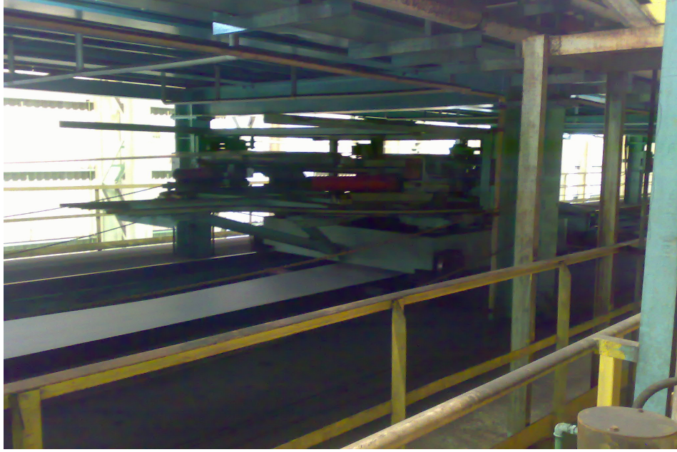
Şekil 6.9: Bobinin asitlenmesinde hattın sürekliliğini sağlayan loop makinesi ve asitlenmiş bobin
