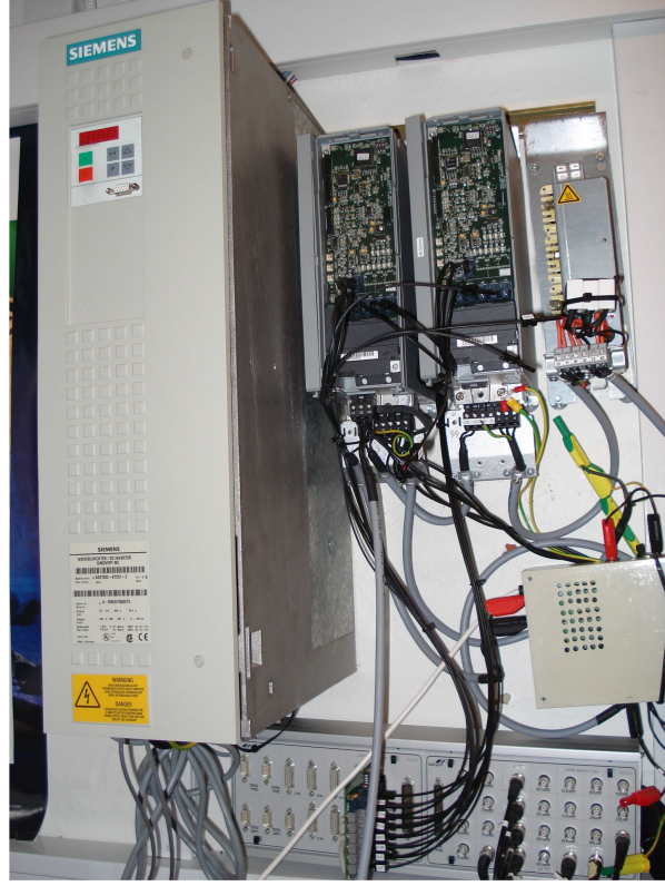
Şekil 4.10: Deneysel çalışmada kullanılan inverter ve PWM parçalarının gösterimi
