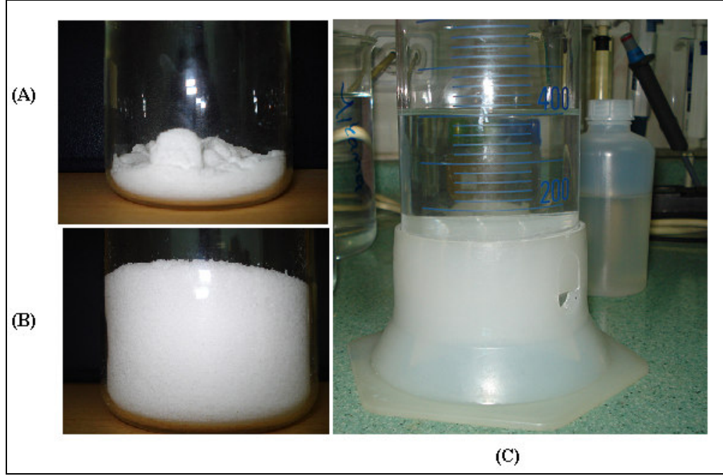
Şekil 4.7 Bileşenlerin çözelti olarak hazırlanması (A) KAg(CN)_2 (B) KCN (C) çözelti hali
