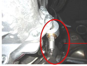
Şekil 5.4: Şanzıman gövdesi ve gövdeye monte edilen ivmeölçer
