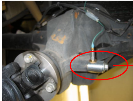
Şekil 5.6: Pinyon dişlisine monte edilen ivmeölçer
