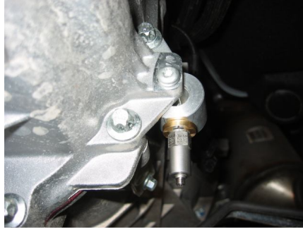
Şekil 7.1: Şanzıman gövdesine monte edilen ivmeölçer
