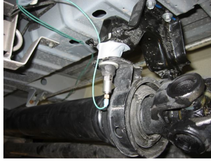
Şekil 7.2: Merkez rulmana monte edilen ivmeölçer
