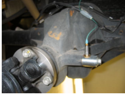
Şekil 7.3: Diferansiyel Üzerinde pinyon dişli kısmına monte edilen ivmeölçer
