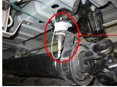
Şekil 5.5: Merkez rulman ve kardan mili askı yatağına monte edilen İvmeölçer
