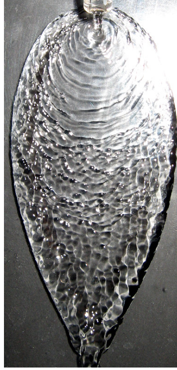
Şekil 4.5: Islanmaz yüzeye yüksek We sayısında çarpan akışkanın anlık görüntüsü ( \theta=102^\circ , d=1.75 mm, \alpha=30^\circ )
