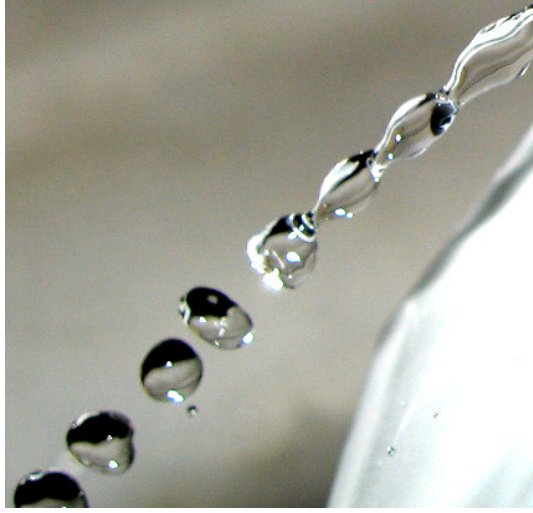
Şekil 4.10: Islanmaz yüzeyden yansıyan suyun havada ilerlerken damlacıklar haline dönüşmesi.
