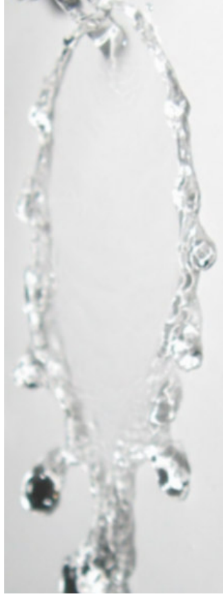
Şekil 4.13: Islanmaz yüzeyde yayılan akışkandaki sıçramaların anlık görüntüsü ( \theta=167^\circ , We=230 , \alpha=45^\circ )
