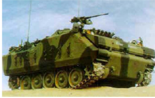
Şekil 2.5: 24 ton ağırlığında FNSS Savunma Sistemleri A.Ş. ile TÜBİTAK Marmara Araştırma Merkezi ortak projesi elektrikli muharebe aracı [2].
