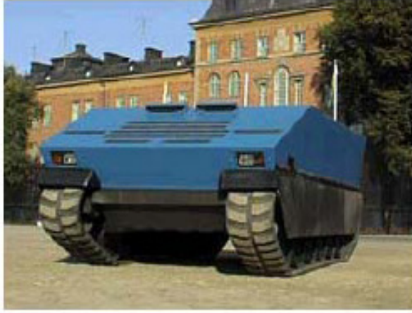
Şekil 2.7: SEP lastik paletli hafif zırhlı elektrikli piyade aracı [2].
