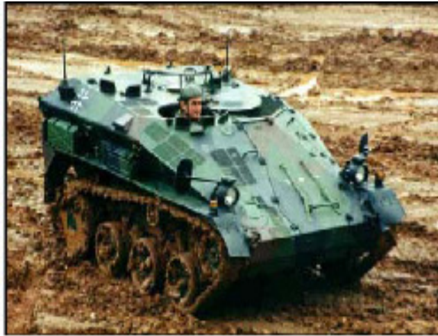
Şekil 2.6: WIESEL elektrikli hafif zırhlı paletli araç [2].
