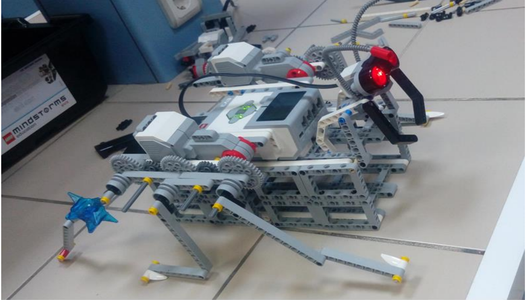
Şekil 3.11. Arı tasarımı – toplayıcı bacak
