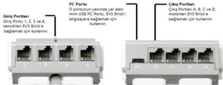
Şekil 2.5. EV3 sensör, usb ve motor bağlantı noktaları
