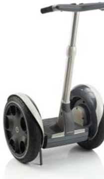
Şekil 1.2: Dinamiği ters sarkaç sistemi ile özdeş olan zencefil ulaşım aracı
