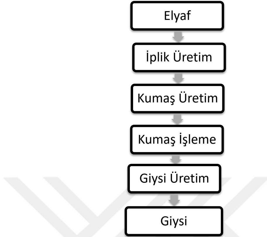
Şekil 9. Tekstil Üretim İşlemleri(Tekstil Fabrika Üretim İşlemlerinden Türetilmiştir.)
